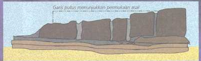
Gelongsoran – bongkah-bongkah yang lemah akan menggelongsor ke bawah
