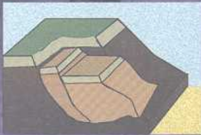
Secara berperingkat – bahagian cerun yang lemah akan runtuh secara berperingkat
