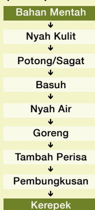
Gambar Rajah 1 Carta alir proses pembuatan kerepek
