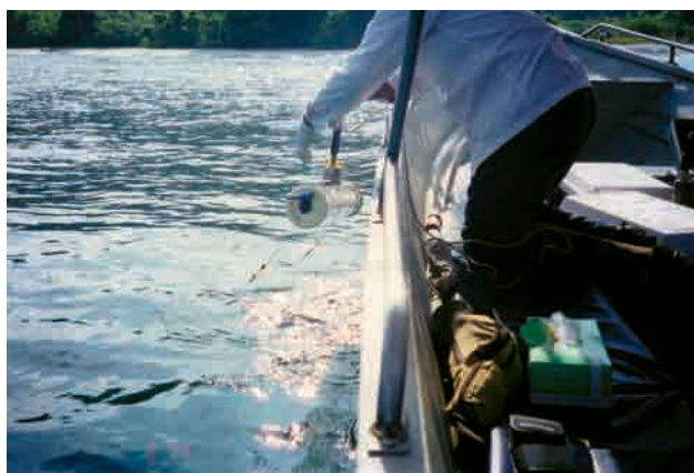
Gambarfoto 5.7 : Pengambilan Sampel Air Laut Dari Bot Menggunakan 'Van Dorn Sampler' Photo 5.7 : Marine Water Sampling Using Van Dorn Sampler
