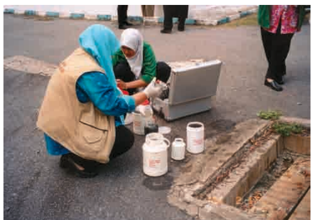
Gambarfoto 5.14 : Persampelan Rasmi Pelepasan Effluen Kilang Photo 5.14 : Formal Sampling of Factory Effluent Discharges
