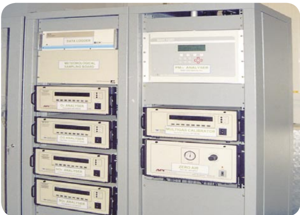
Gambarfoto 5.1 JAS: Peralatan untuk Analisis Pencemaran Udara di Stesen Pemantauan Photo 5.1 DOE : Air Pollution Analytical Instruments at Monitoring Station
