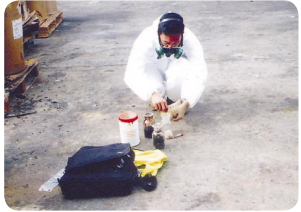
Gambarfoto 5.18 JAS: Persampelan Rasmi Buangan Toksid dan Berbahaya Photo 5.18 DOE: Formal Sampling of Toxic and Hazardous Wastes
