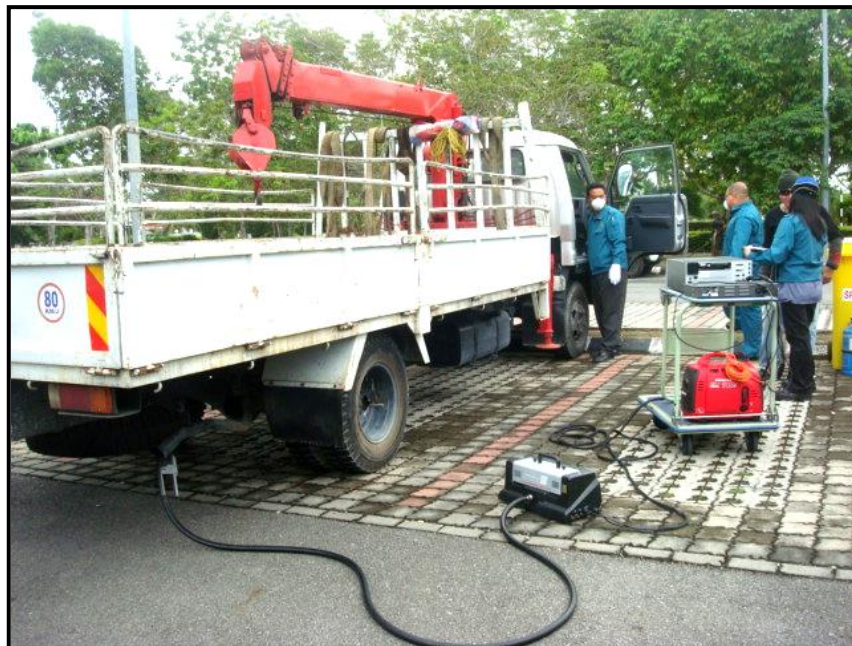
Pengujian tahap pelepasan asap hitam dari kenderaan yang dilesenkan sebagai kenderaan pengangkut buangan terjadual
