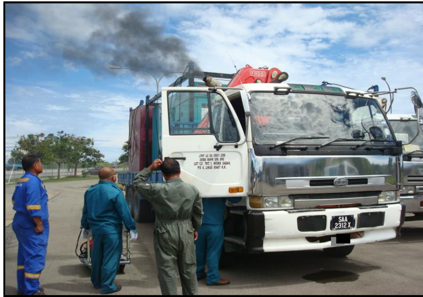
Pengujian tahap pelepasan asap hitam dari kenderaan diesel
