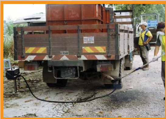
Gambar 3.6 : Operasi Pelepasan Asap Hitam Dari Kenderaan Diesel
