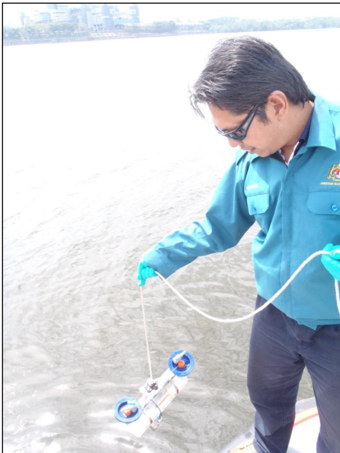
Plat 5.4 : Pengambilan sampel bagi program pemantauan kualiti air marin di Selat Johor dengan menggunakan Water Depth Sample .
