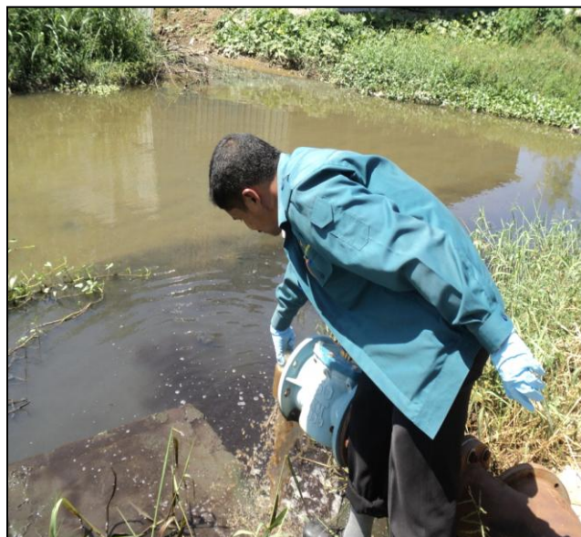
Gambarfoto 3.3: Persampelan di takat pelepasan akhir kilang
