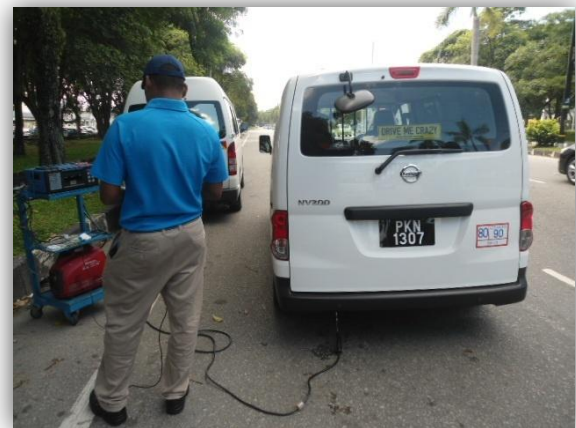
Gambarfoto 3.15: Kenderaan petrol sedang diuji bagi pemantauan pelepasan dari gas enjin petrol (CO/HC)
