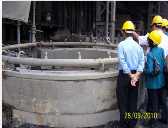
Gambarfoto 5.9: Keadaan kawasan punca pelepasan asap perang dari proses granulasi sanga timah sebelum pemasangan sistem "scrubber"
