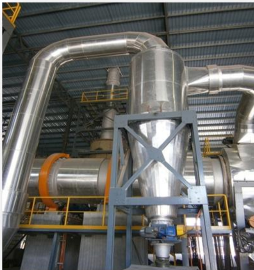
Gambarfoto 4.7: AKPU- Siklon untuk merawat habuk bersaiz sederhana
