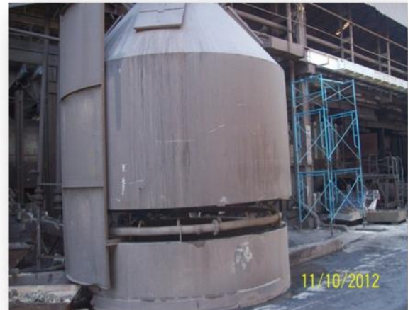
Gambarfoto 5.10: Suction hood yang menyalurkan asap perang ke sistem "scrubber" setelah penambahbaikan untuk mengawal pelepasannya
