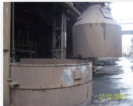
Gambarfoto 5.12: Penambahbaikan terkini yang dilakukan pihak premis iaitu pemasangan plat besi di sekeliling kolam untuk meningkatkan kecekapan sistem
