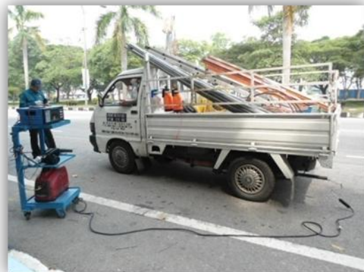
Gambarfoto 3.15 : Kenderaan petrol sedang diuji bagi pemantauan pelepasan
