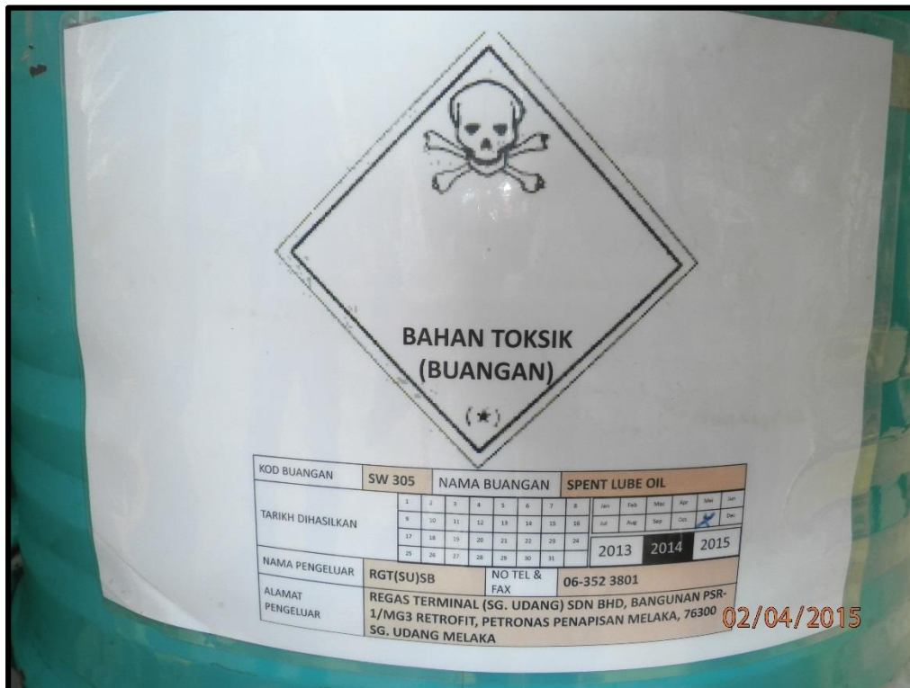
Gambar 3.7 : Pemeriksaan Label Buangan Terjadual
