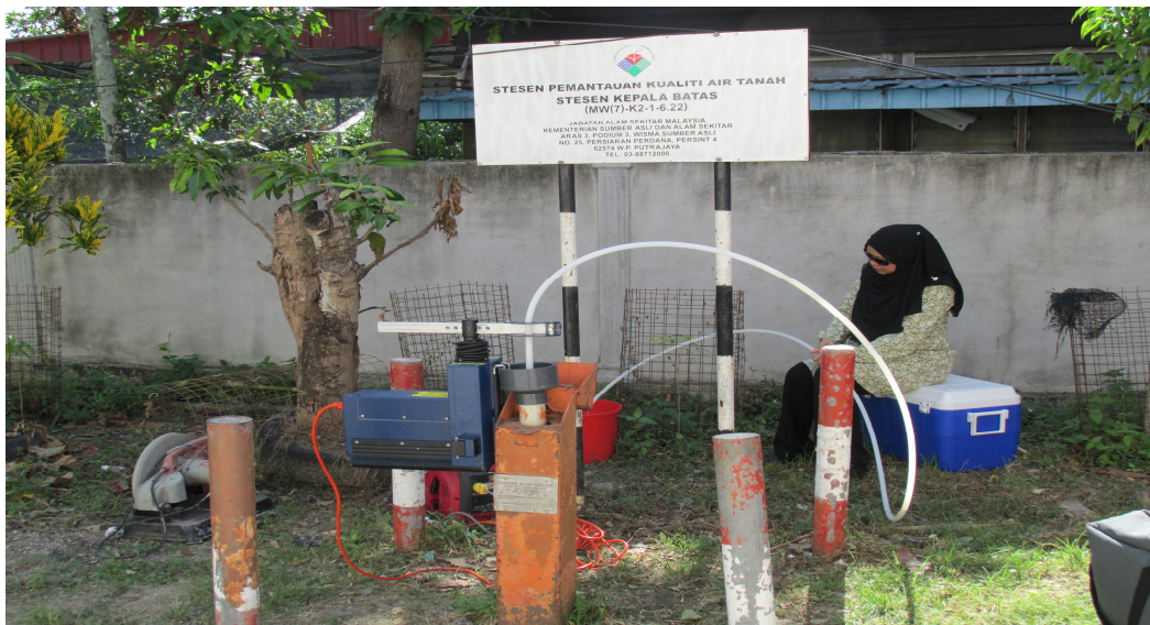
Proses persampelan Air Tanah
