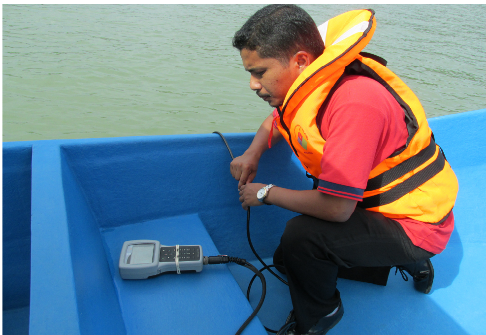
Proses Mendapatkan Bacaan Parameter In – situ Air Laut
