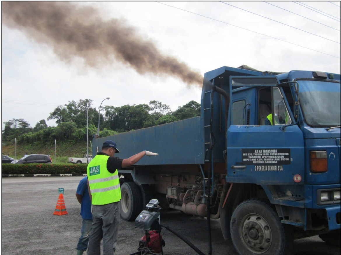
Gambar ujian pelepasan asap hitam dari kenderaan berenjin diesel
