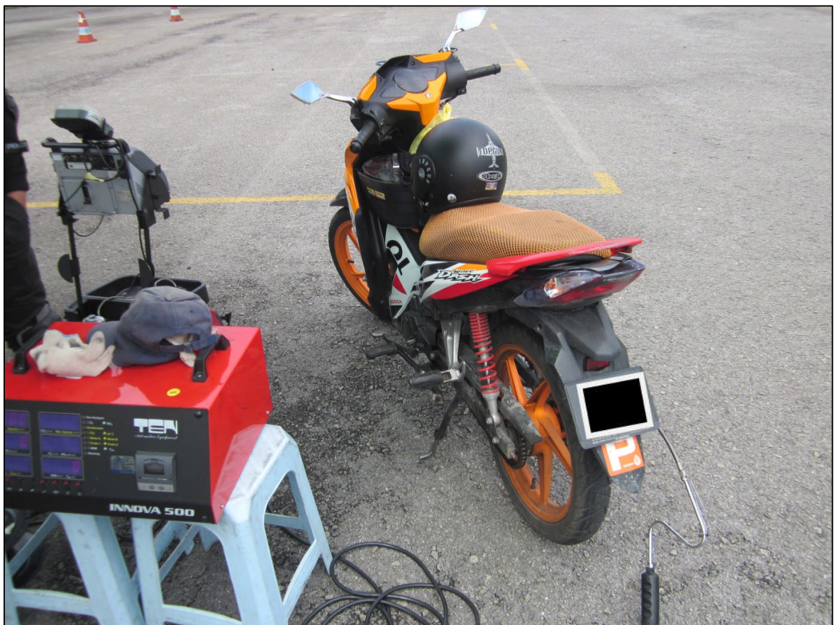
Gambar ujian pelepasan gas daripada enjin motosikal
