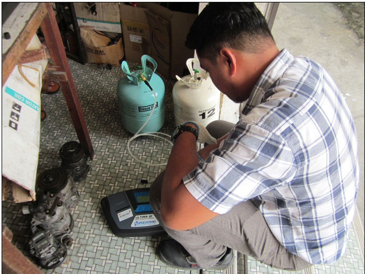
Gambar pemeriksaan tong refrigeran di bengkel air-cond kenderaan menggunakan alat Refrigerant Identifier (RI)
