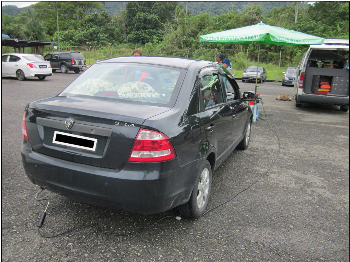
Gambar ujian pelepasan gas CO dan HC dari kenderaan berenjin petrol
