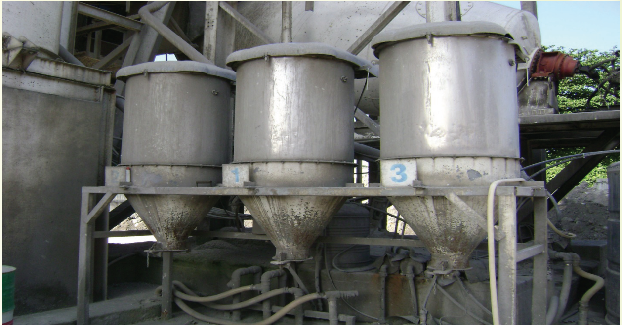
Gambar 3(e): Tiga (3) Unit Bag Filter yang dipasang di dalam Premis Loji Pembancuh Konkrit Megamix
