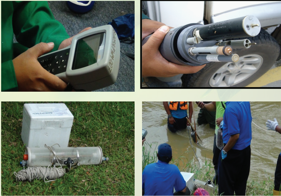
Gambar 1 : Peralatan- Peralatan yang Digunakan untuk Persampelan dan Bacaan In-Situ Kualiti Air Sungai
