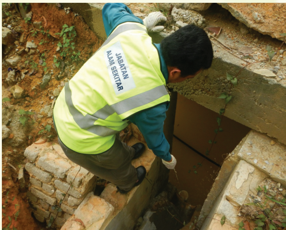
Gambar3(a): Persampelan insitu bagi pelepasan pepejal terampai daripada silt trap
