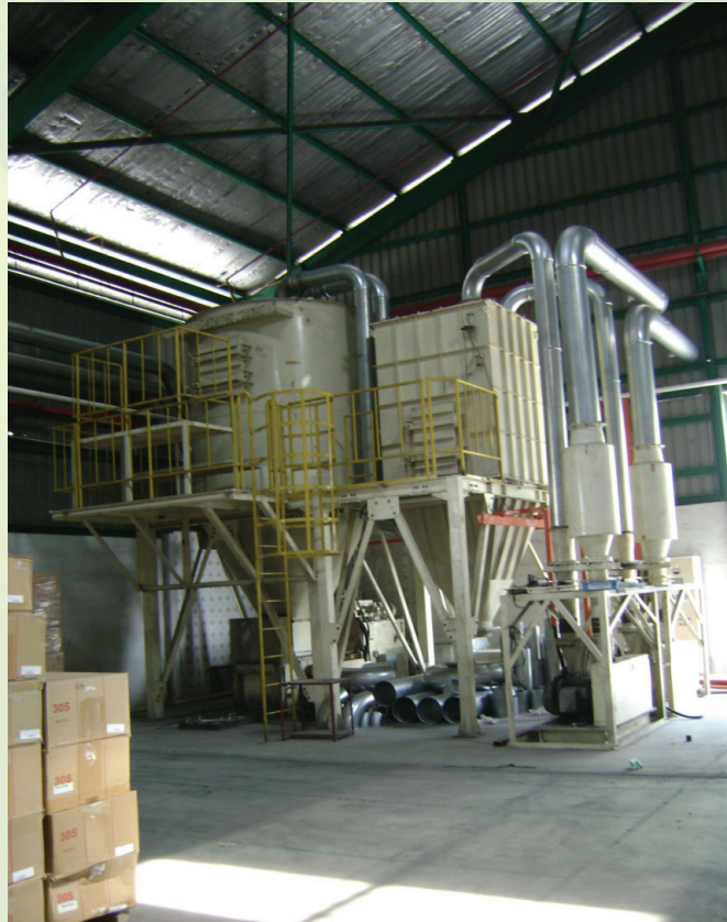
Gambar 3(c): Lawatan bagi permohonan penempatan semula dust collector di Premis Naito Asia Sdn. Bhd.
