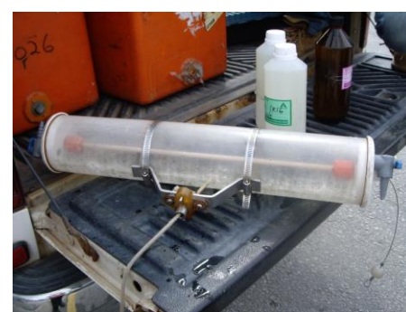
Peralatan Yang Digunakan Untuk Persampelan Dan Bacaan In-Situ Kualiti Air Sungai
