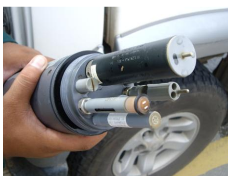
Peralatan Yang Digunakan Untuk Persampelan Dan Bacaan In-Situ Kualiti Air Sungai
