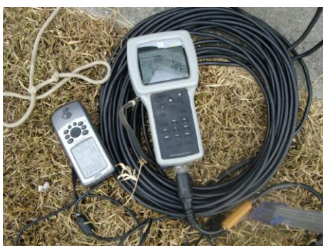
Peralatan Yang Digunakan Untuk Persampelan Dan Bacaan In-Situ Kualiti Air Sungai
