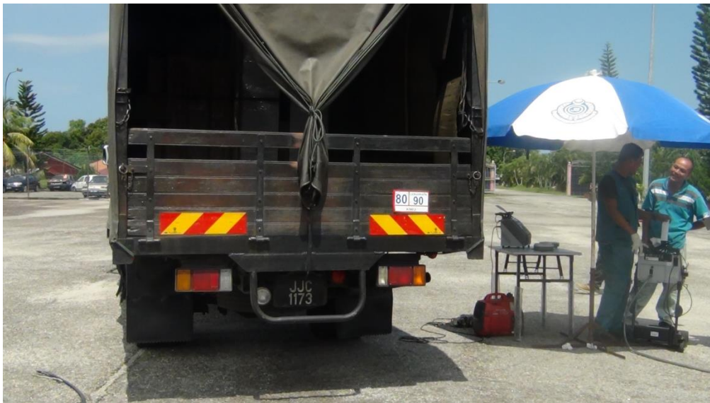
Gambar 2.2.1 Kelantan : Pengujian Pelepasan Asap Daripada Kenderaan Diesel Semasa Ops Statik.
