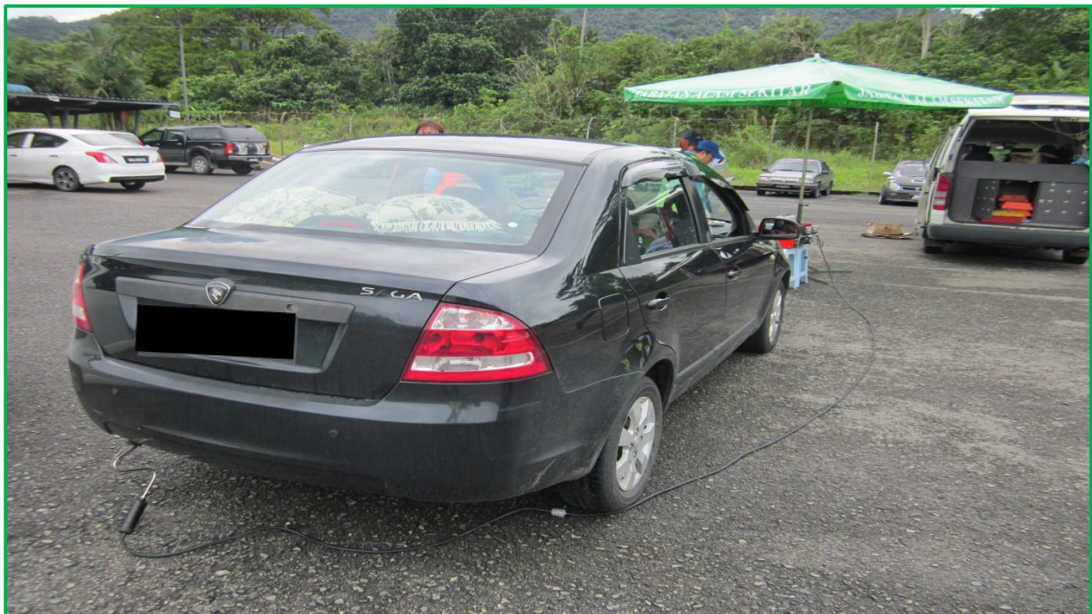
Gambar ujian pelepasan gas CO dan HC dari kenderaan berenjin petrol
