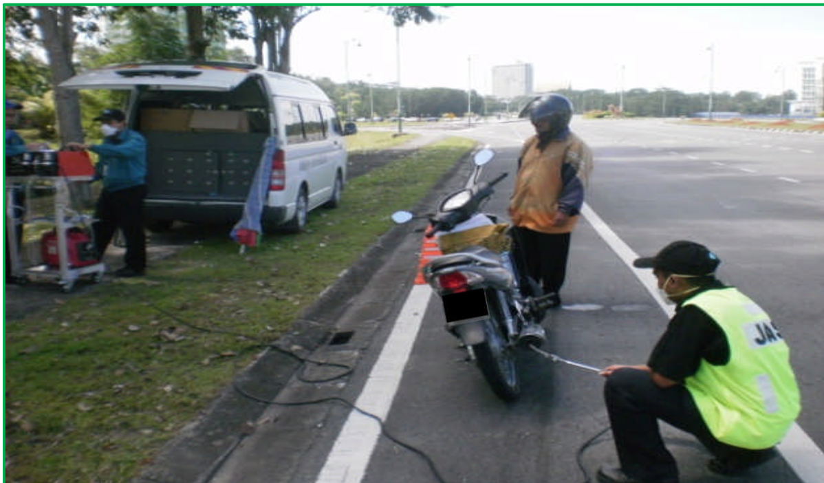
Gambar ujian pelepasan bergas daripada enjin motosikal
