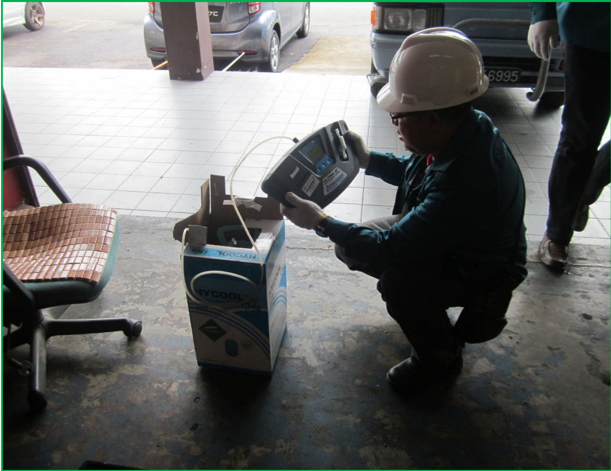
Gambar kerja-kerja pengujian tong refrigeran yang terdapat di bengkel kenderaan menggunakan alat Refrigerant Identifier (RI)
