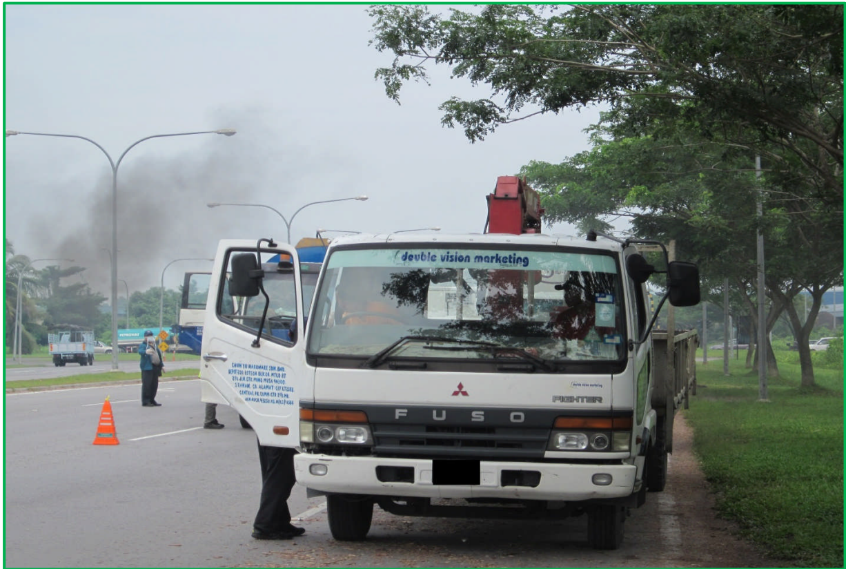
Gambar operasi statik untuk ujian pelepasan asap hitam dari kenderaan berenjin diesel
