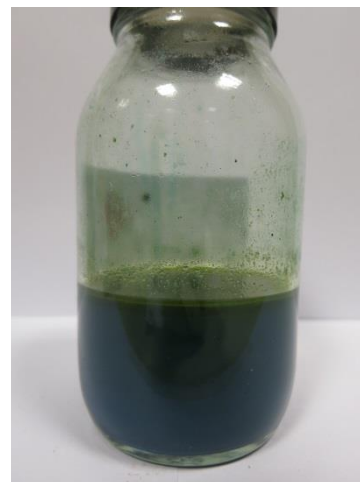
Enapcemar dakwat daripada proses percetakan
