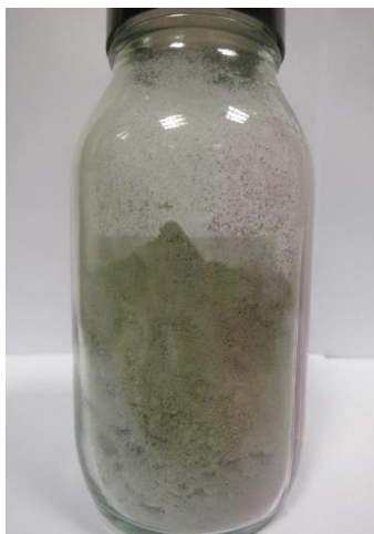
Enapcemar dakwat daripada proses percetakan
