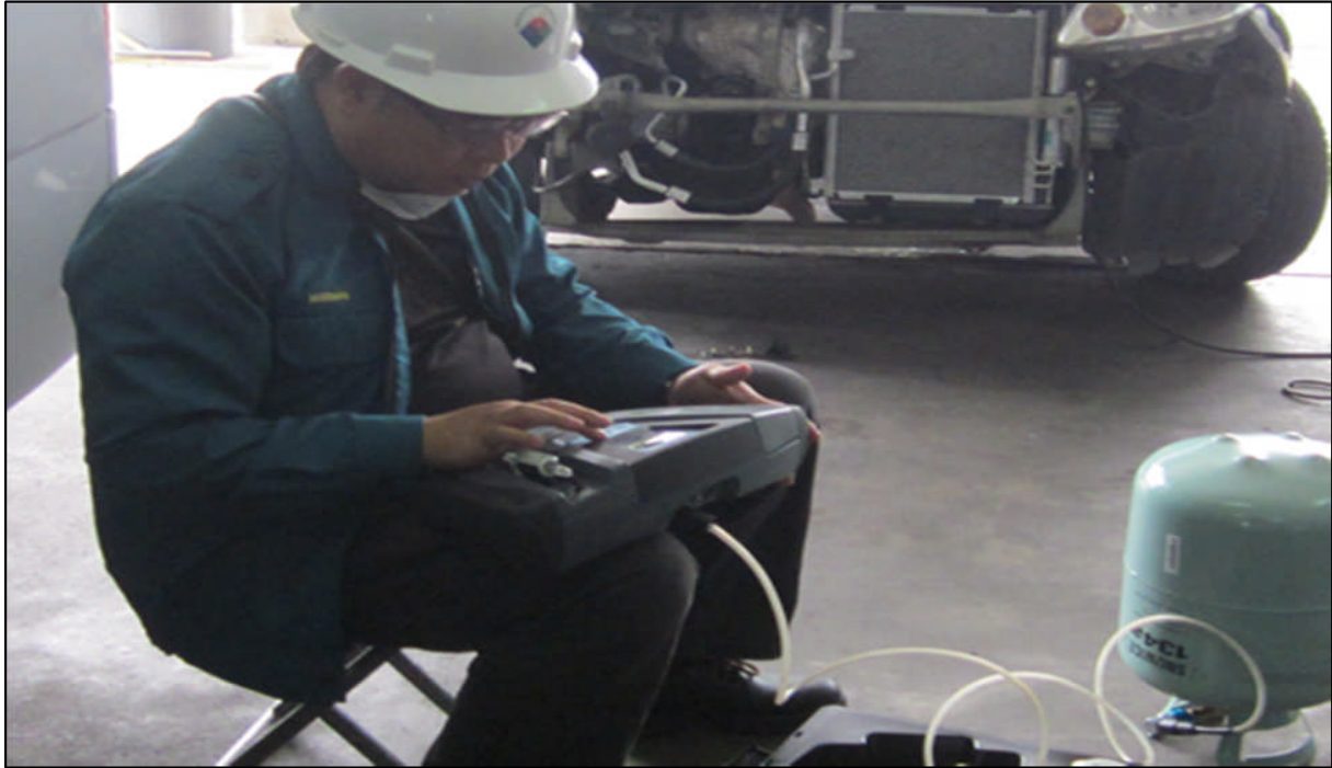
Kerja-kerja pengujian gas refrigeran di bengkel kenderaan bermotor
