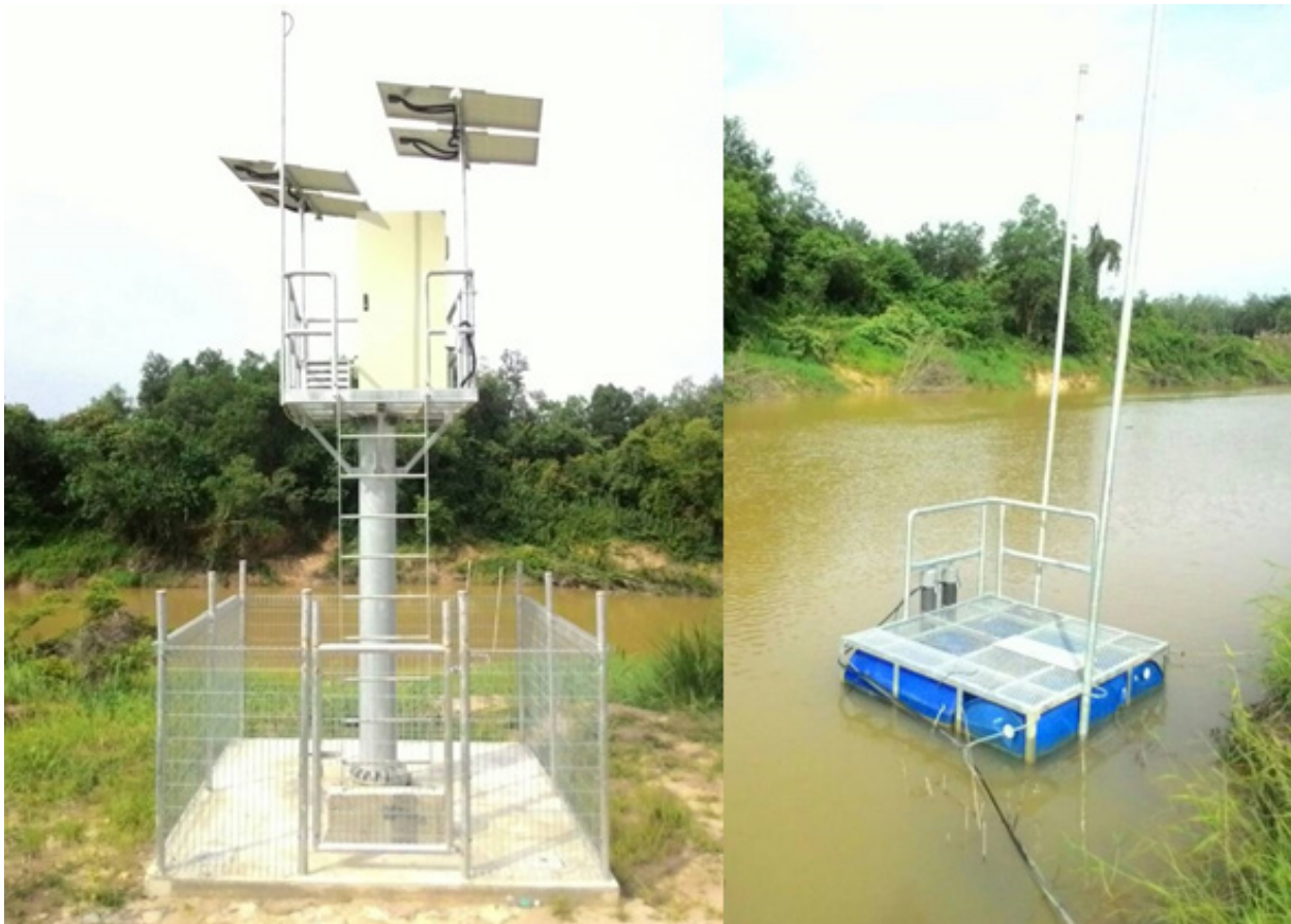
Gambar 6.4 JAS Negeri Johor: Stesen pengawasan kualiti air sungai automatik beserta deployment bagi Sungai Segamat
