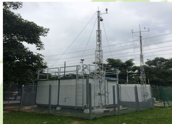
Gambar 6.2 JAS Negeri Johor: Stesen Pemantauan Kualiti Udara Automatik (CAQM)
