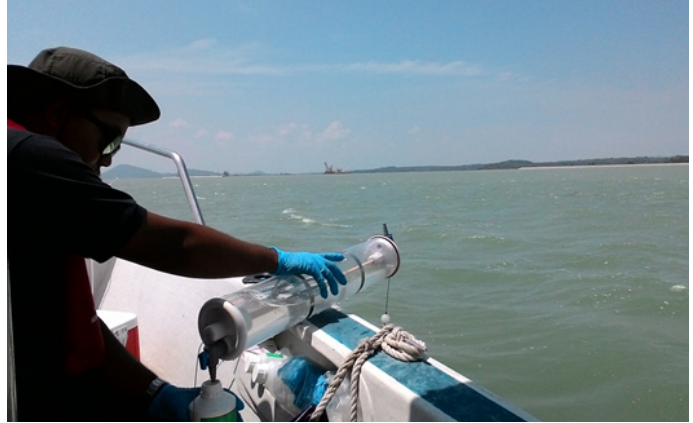
Gambar 6.10 JAS Negeri Johor: Pengambilan sampel air marin untuk analisis kimia di makmal dengan menggunakan alat persampelan air Van Dorn bagi stesen manual
