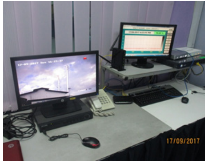
Gambar 4.4 JAS Negeri Johor: Pelepasan asap yang dipantau melalui Continuous Emission Monitoring System (CEMS) sepanjang masa
