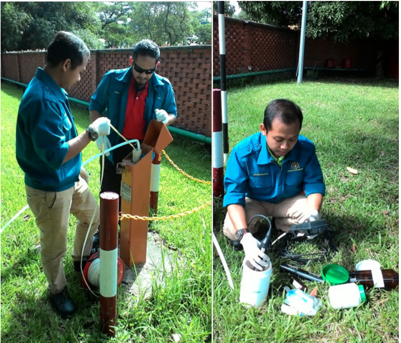
Gambar 6.5 JAS Negeri Johor: Kerja persampelan air tanah yang melibatkan pengukuran kedalaman air dalam telaga dan analisa parameter in-situ bagi sampel air tanah
