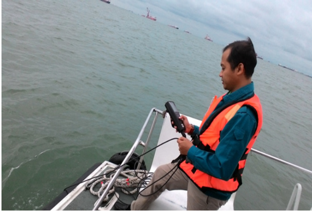
Gambar 6.9 JAS Negeri Johor: Pengukuran kualiti air marin in-situ menggunakan alat multiprobe YSI Pro-DSS bagi stesen manual
