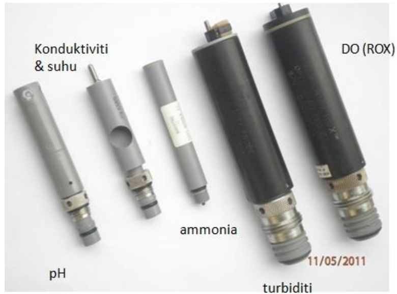
Gambarajah 11.2. Contoh-contoh prob YSI Multi Parameter Water Quality Sonde
