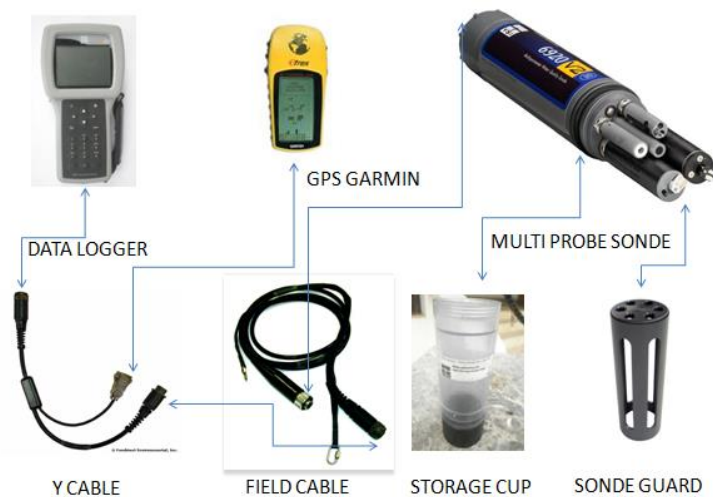
Gambarajah 11.1. Peralatan Multi Parameter Water Quality Sonde yang biasa digunakan dalam pengawasan air tanah
