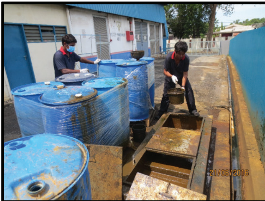
Gambar 3 : Tindakan penambahbaikan penstoran bagi Enap cemar SW204 daripada proses penyaduran tembaga yang tidak terawat oleh pihak premis.
