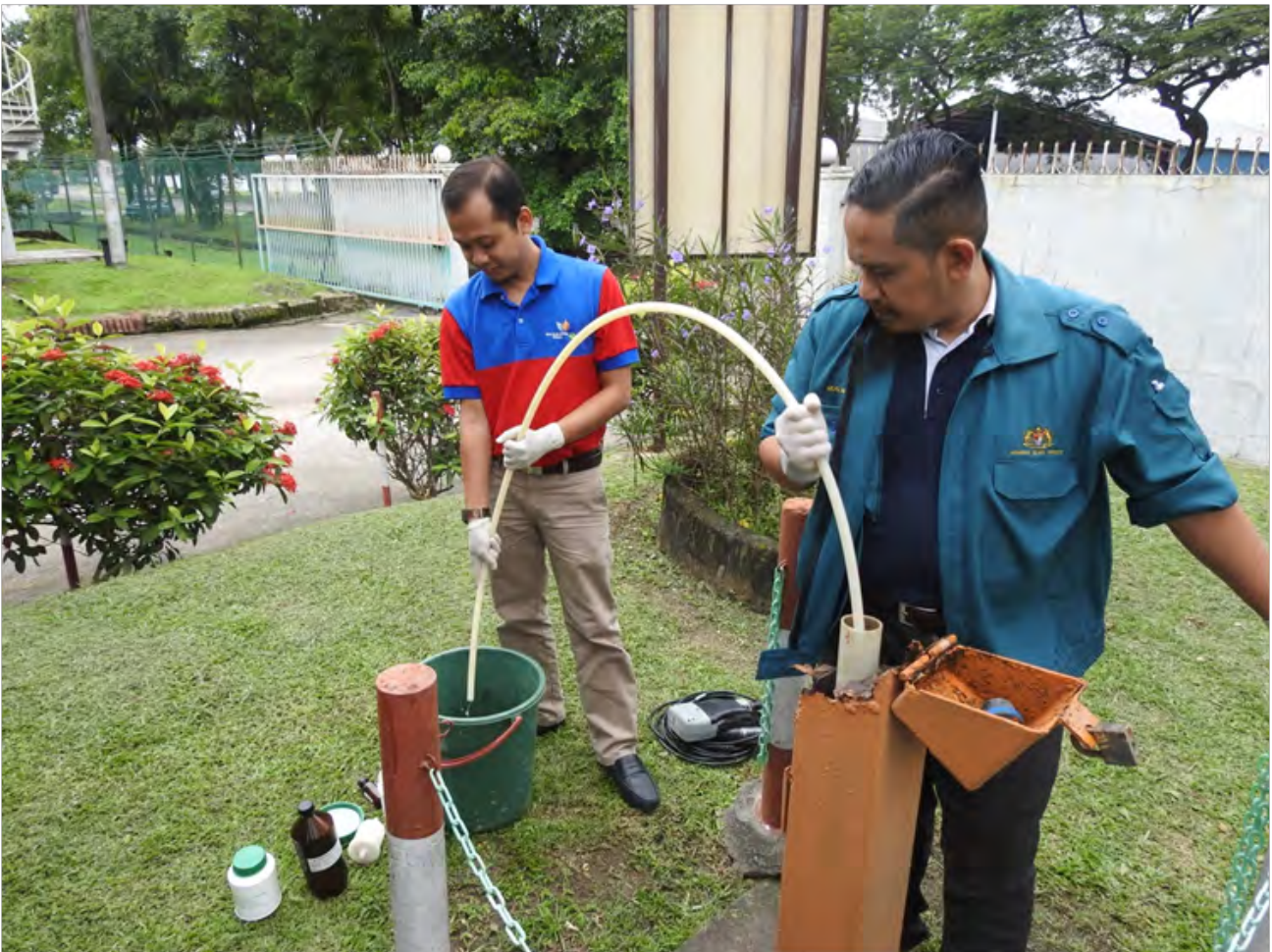
Gambar 6.9 : Proses purging sebelum pengambilan sampel air tanah.
