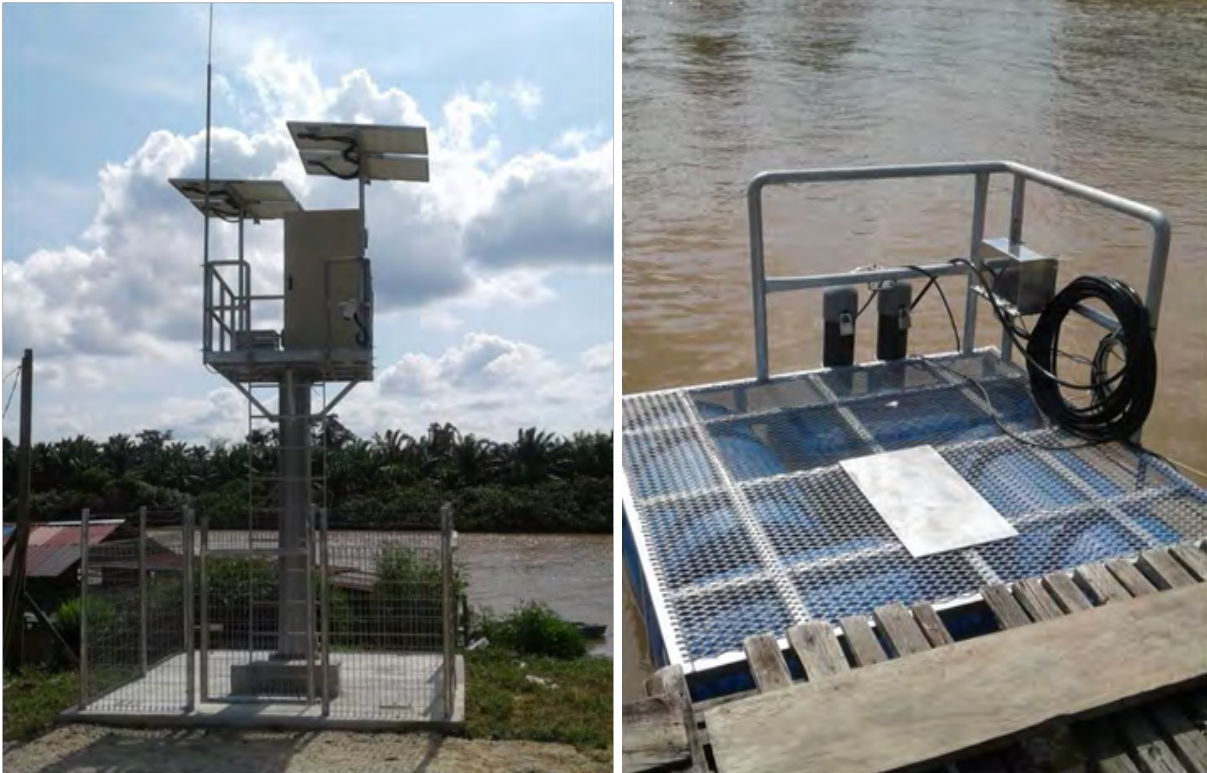
Gambar 6.6 : Stesen pengawasan kualiti air sungai automatik beserta deployment bagi Sungai Muar (intake Panchor), Johor.
