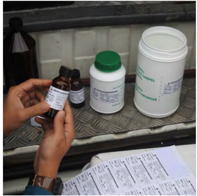
Gambar 6.8 : Persediaan pengawetan & pelabelan botol sampel sebelum kerja persampelan air tanah.
