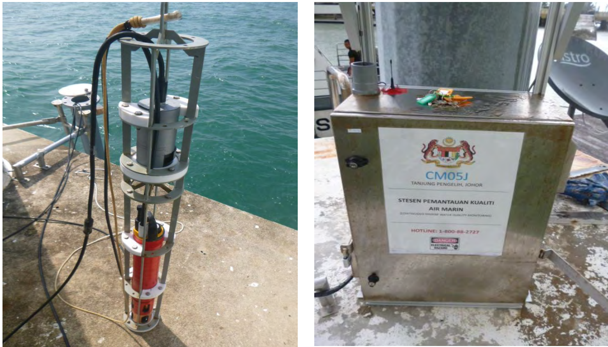
Gambar 6.10 : Stesen pengawasan kualiti air marin automatik beserta sondedi Jeti Jabatan Laut Malaysia, Tanjung Pengelih, Johor.
