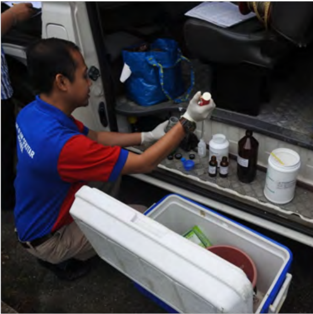
Gambar 6.8 : Persediaan pengawetan & pelabelan botol sampel sebelum kerja persampelan air tanah.
