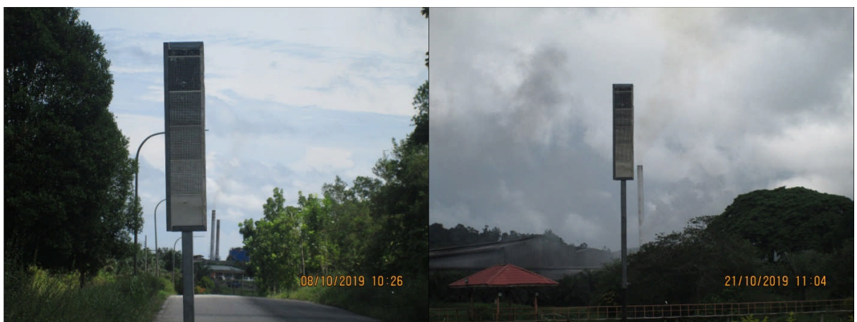
Foto 3.3: Pemerhatian asap hitam cerobong premis KKS menggunakan Carta Ringelman.
