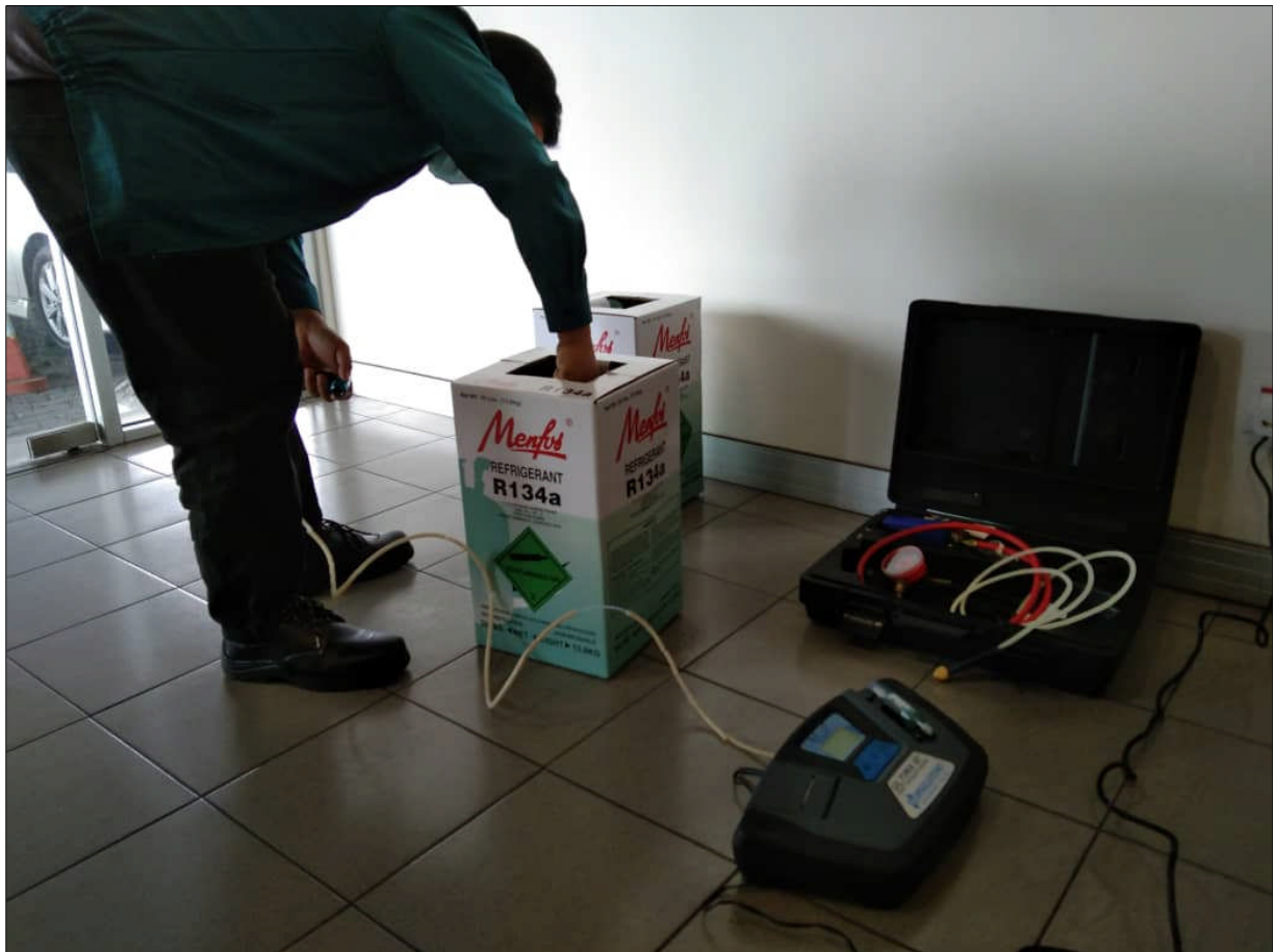
Foto 3.16: Gambar semasa kerja-kerja pengujian gas refrigeran di bengkel kenderaan bermotor
