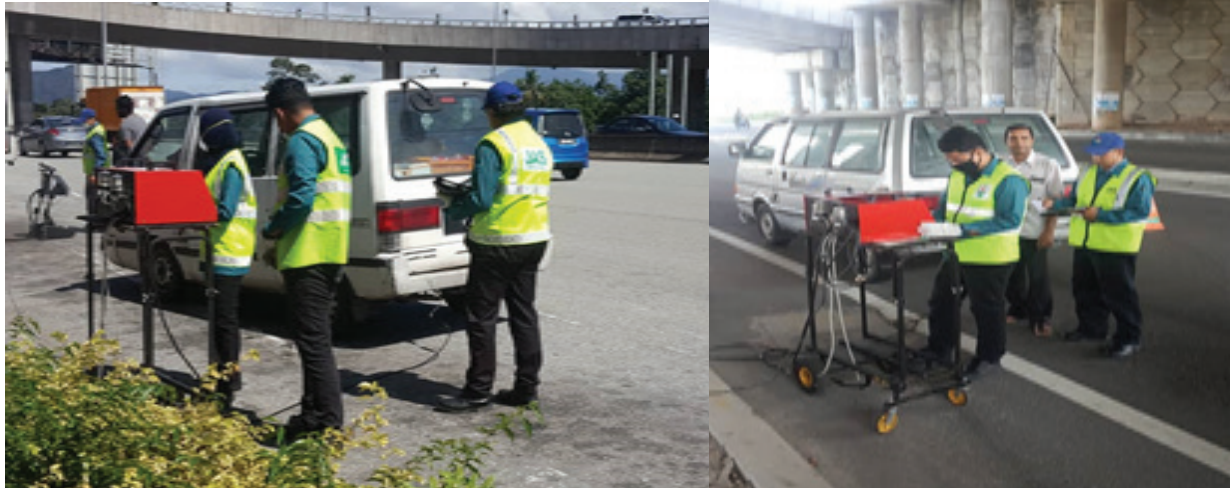
Operasi Pelepasan Gas CO/HC daripada Kenderaan Berenjin Petrol
