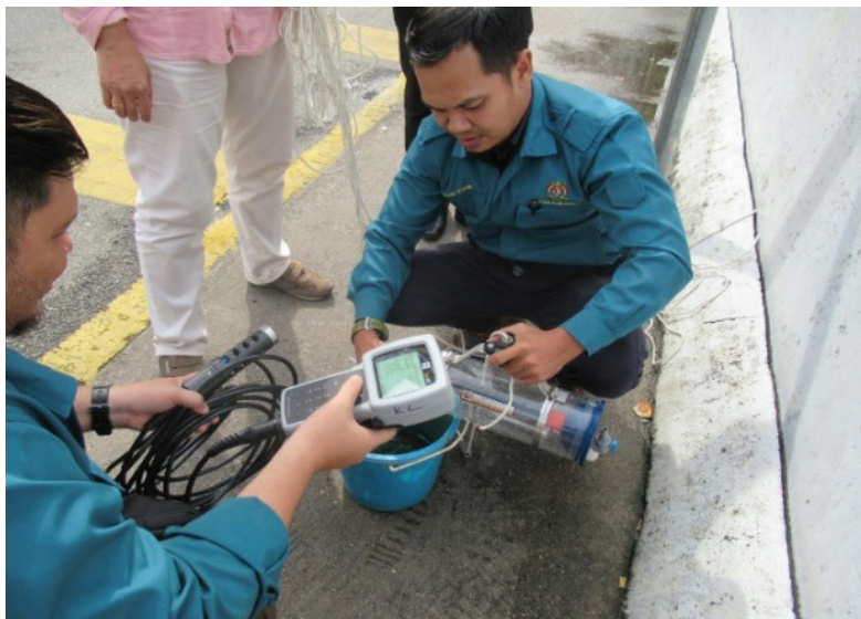
Persampelan in-situ di stesen manual air sungai
