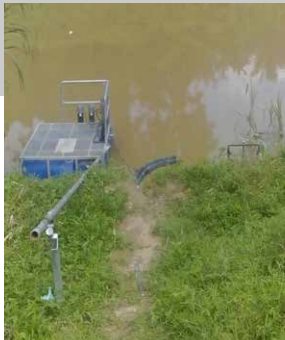
Gambar 6.3 : Stesen pengawasan kualiti air sungai automatik beserta deployment bagi Sungai Skudai (intake Skudai), Johor.
