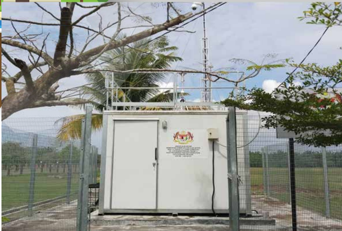
Gambar 6.2 : Stesen Pemantauan Kualiti Udara Automatik (CAQM) di MRSM Batu Pahat, Johor.
