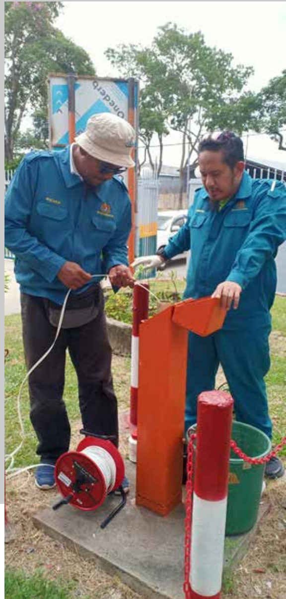
Gambar 6.4 : Pengukuran kedalaman "water column" bagi kerja persampelan air tanah.
