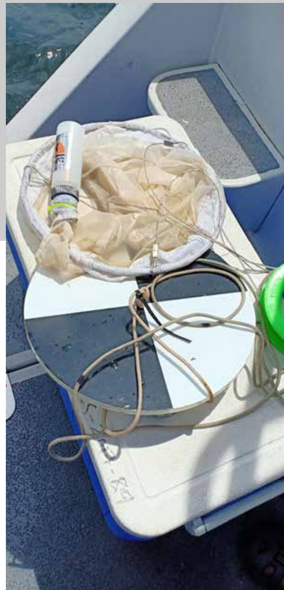
Gambar 6.8 : Pengambilan sampel air marin untuk analisis kimia di makmal dengan menggunakan alat persampelan air Van Dorn bagi stesen manual.
