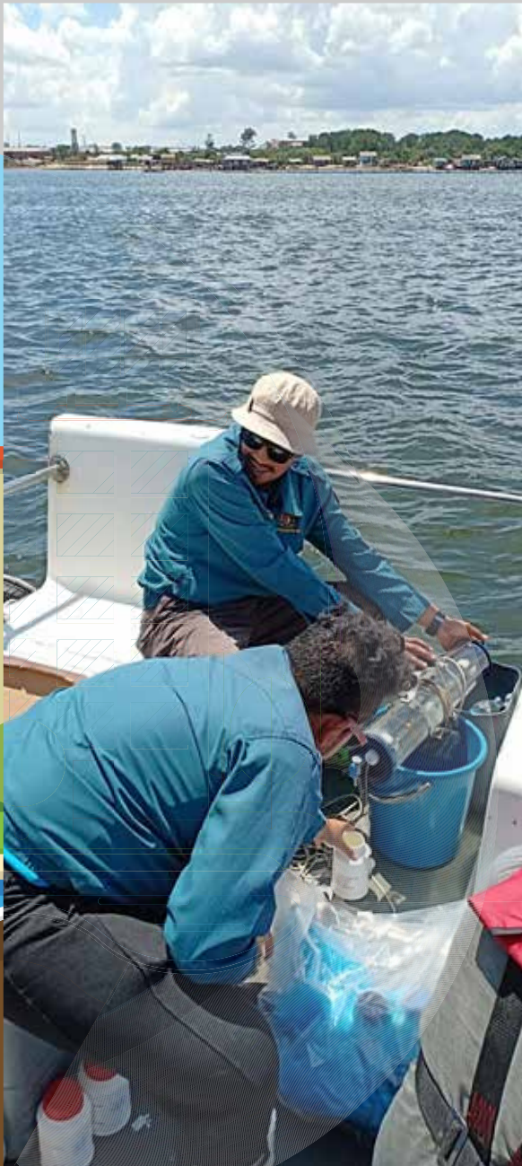
Gambar 6.8 : Pengambilan sampel air marin untuk analisis kimia di makmal dengan menggunakan alat persampelan air Van Dorn bagi stesen manual.
