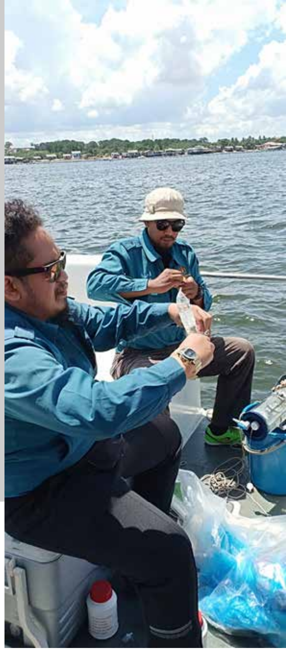
Gambar 6.8 : Pengambilan sampel air marin untuk analisis kimia di makmal dengan menggunakan alat persampelan air Van Dorn bagi stesen manual.
