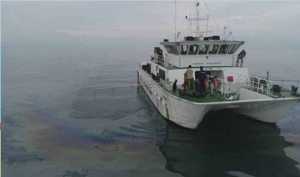
Gambar 9.19 : dispersant arm spray (Slickgon NS) dan absorbent boom digunakan oleh Jabatan Laut bagi mengawal pergerakan minyak ke pantai
