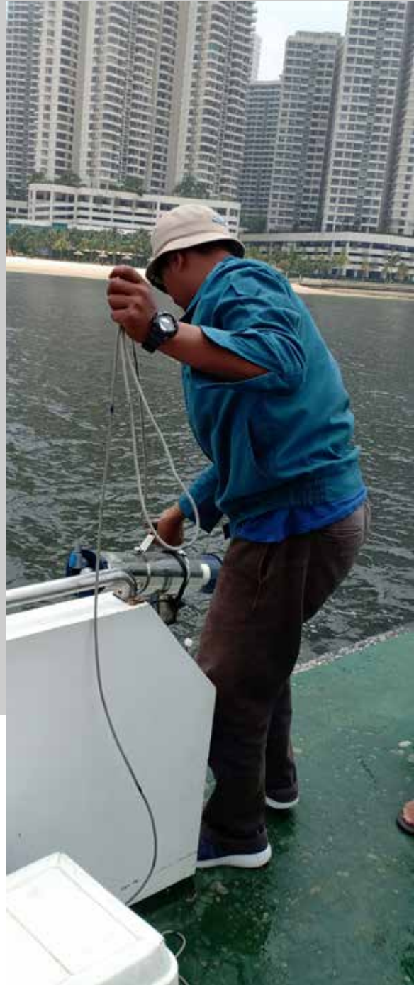
Gambar 6.7 : Pengambilan sampel air marin untuk analisis kimia di makmal dengan menggunakan alat persampelan air Van Dorn bagi stesen manual.
