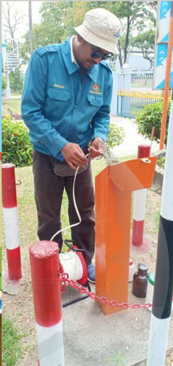
Gambar 6.4 : Pengukuran kedalaman "water column" bagi kerja persampelan air tanah.
