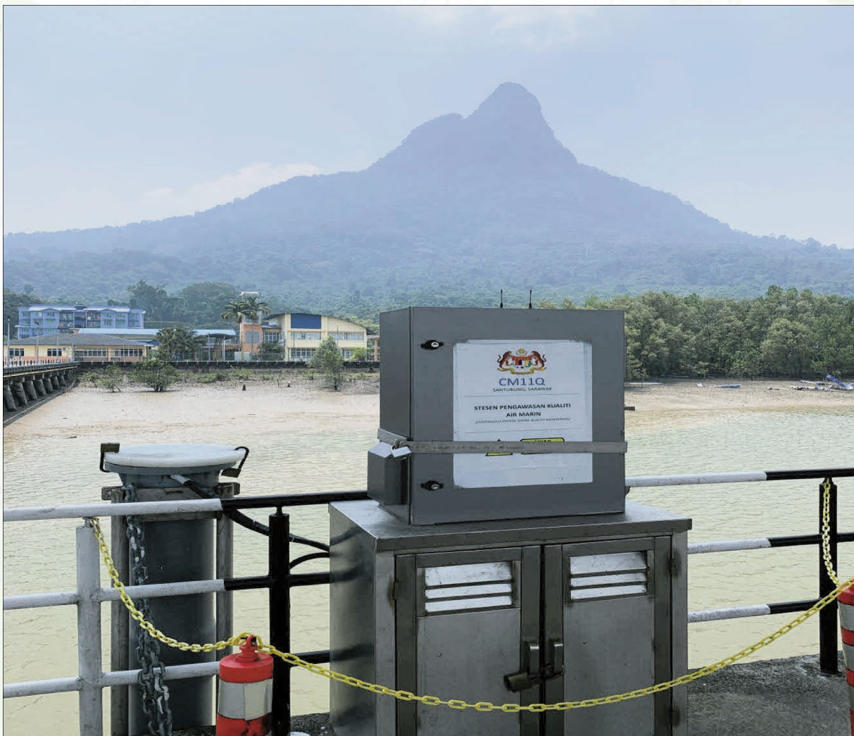
Foto 4.4: Stesen pengawasan kualiti air marin automatik
