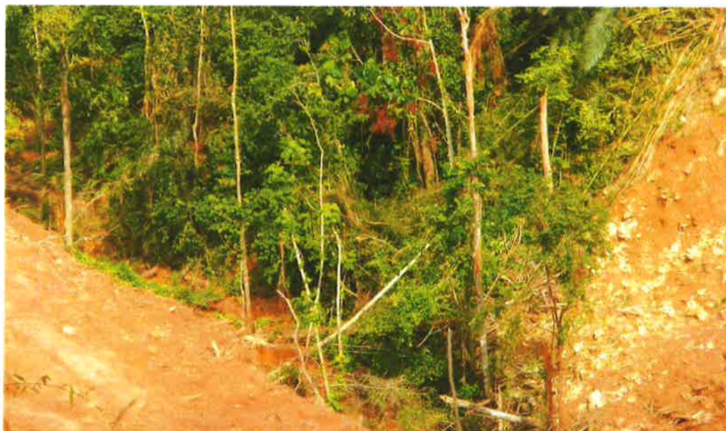
Gambar 9: Overburden tidak diuruskan dengan betul dan ditolak menimbus alur air
