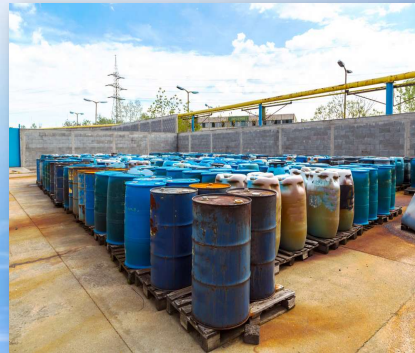
Penstoran Yang Tidak Patuh
