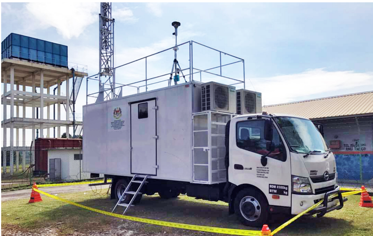
Stesen Pengawasan Kualiti Udara Bergerak yang Ditempatkan di Lokasi Johan Setia, Klang, Selangor bagi Memantau Tahap Kualiti Udara Setempat di Kawasan Tersebut Mobile Continuous Air Quality Monitoring Station (MCAQM) Placed at Johan Setia, Klang, Selangor to Monitor the Level of Ambient Air Quality at the Specified Location
