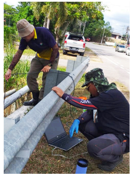
Persampelan Kualiti Air Sungai Merlimau Menggunakan Alat YSI EXO2 Multiparameter Sonde. Water Quality Sampling of Merlimau River Using YSI EXO2 Multiparameter Sonde Probe.
