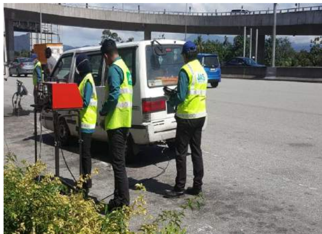
Foto 7 : Operasi Pelepasan Gas CO/HC daripada Kenderaan Berenjin Petrol
