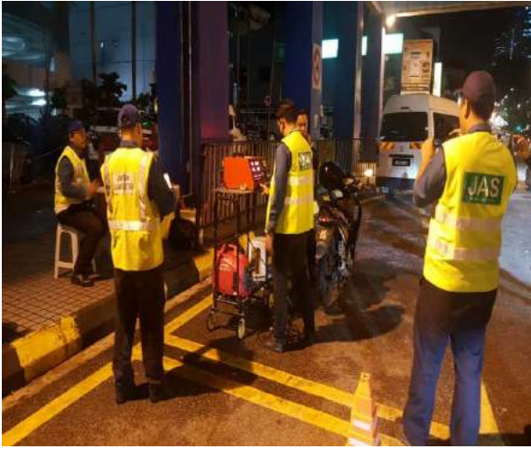
Foto 9 : Operasi Pelepasan Gas CO daripada Motosikal
