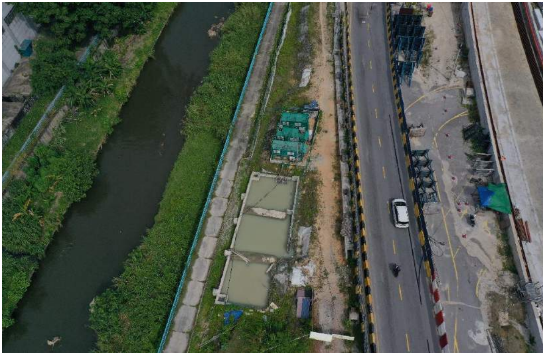
Foto 19 : Pemeriksaan "Silt Pond & Waste Water Treatment Plant" menggunakan drone
