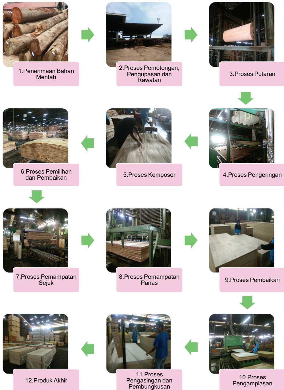
Rajah 8-3 Carta Alir Proses Penghasilan Produk Berasaskan Kayu ( Plywood, Veneer dan LVL )
