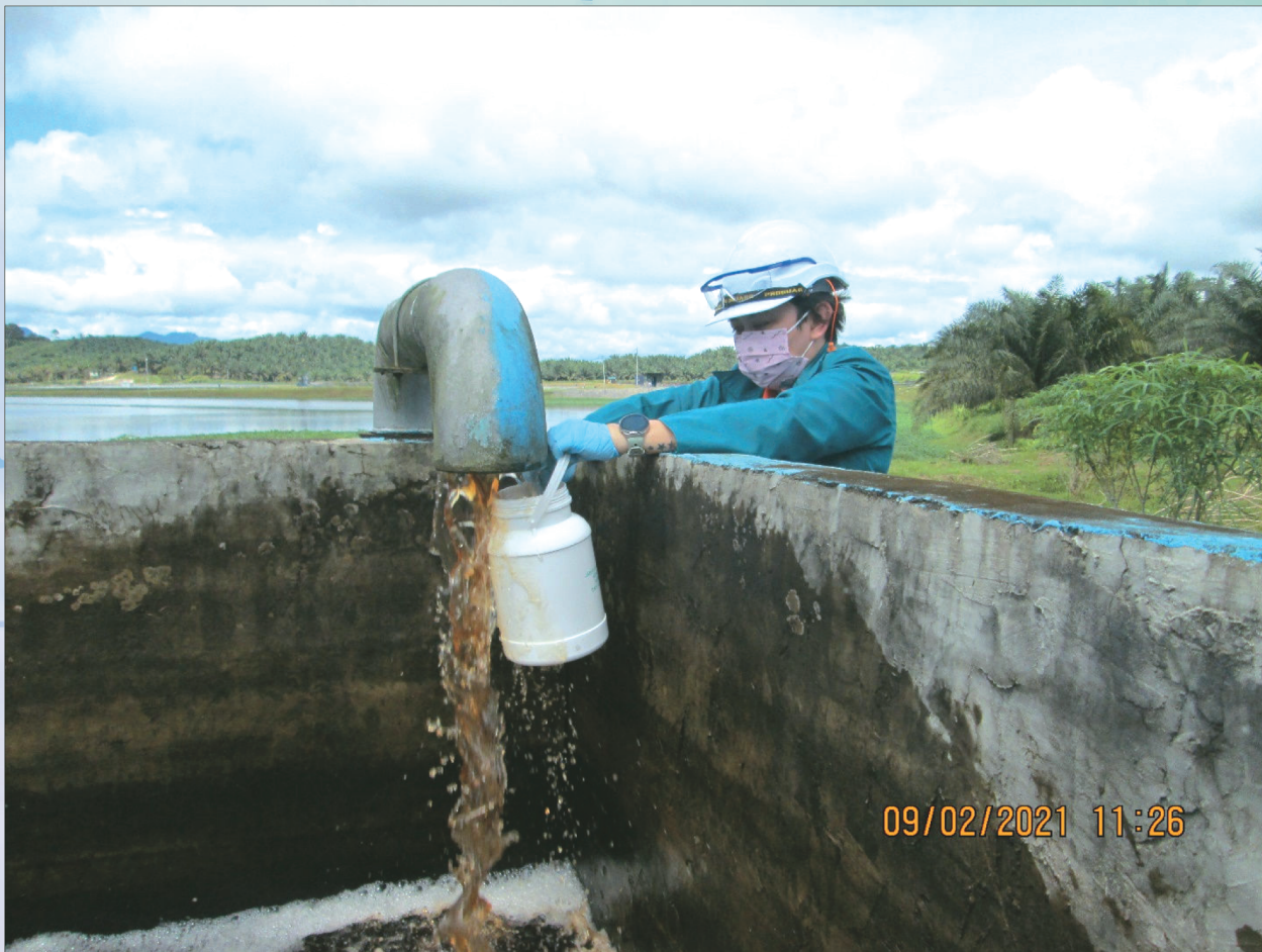
Foto 3.1: Persampelan efluen di takat pelepasan akhir premis KKS
