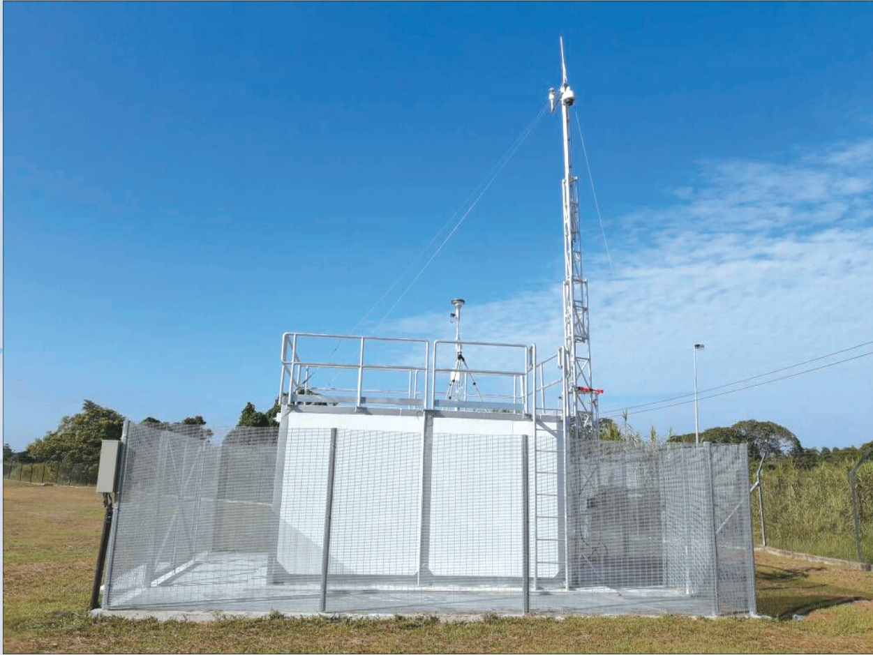
Foto 4.9: Stesen pengawasan kualiti udara automatik (CAQM) yang terletak di Mukah, Sarawak
