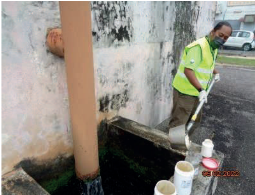
Gambar 3.14: Kerja-kerja persampelan kumbahan sedang dilakukan terhadap sistem pengolahan kumbahan IWK .
