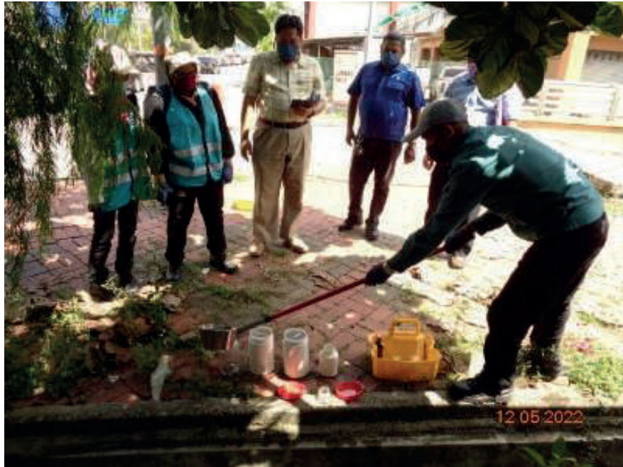
Gambar 3.16: Kerja-kerja persampelan kumbahan sedang dilakukan - sistem pengolahan kumbahan persendirian .
