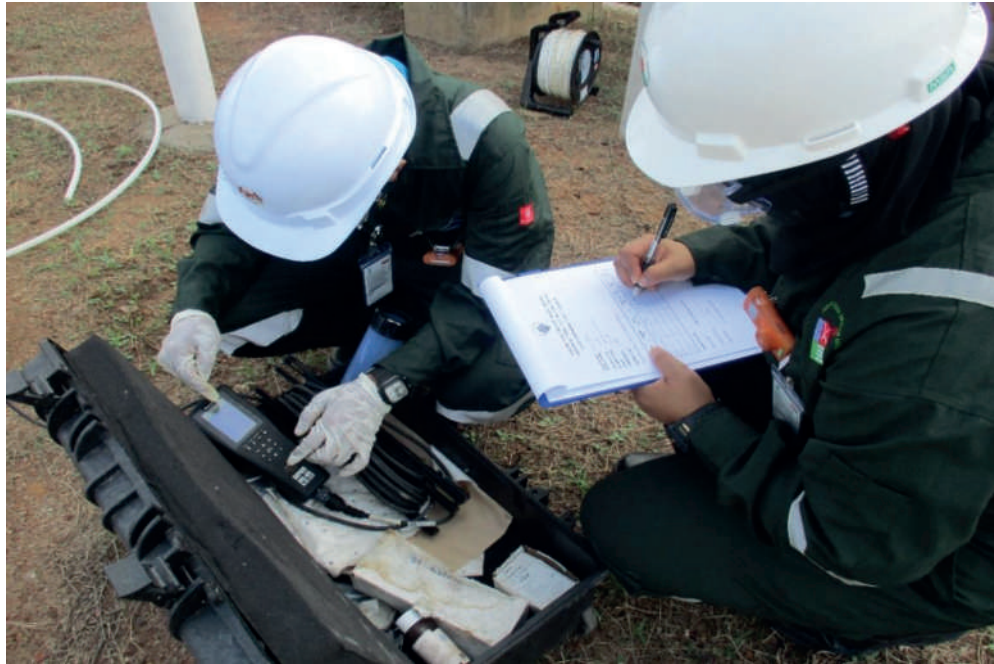
Gambar 4.42: Aktiviti persampelan kualiti air bawah tanah di Stesen Air Bawah Tanah, Loji Penapisan Petronas Sungai Udang
