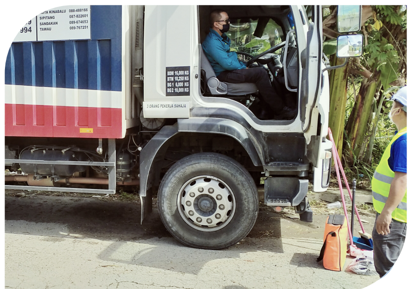
Gambarajah 5.10 : Beberapa kenderaan yang sedang diuji dengan alat ujian asap hitam di PUSPAKOM.
