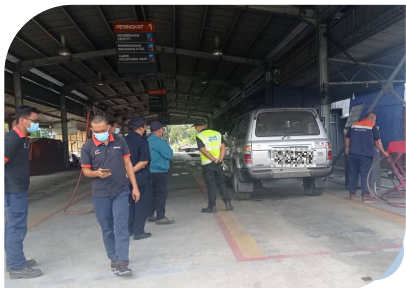
Gambarajah 5.9 : Beberapa kenderaan yang sedang diuji dengan alat ujian asap hitam di PUSPAKOM
