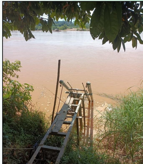
Gambar 2.7 Kelantan: Stesen pengawasan kualiti air sungai automatik
