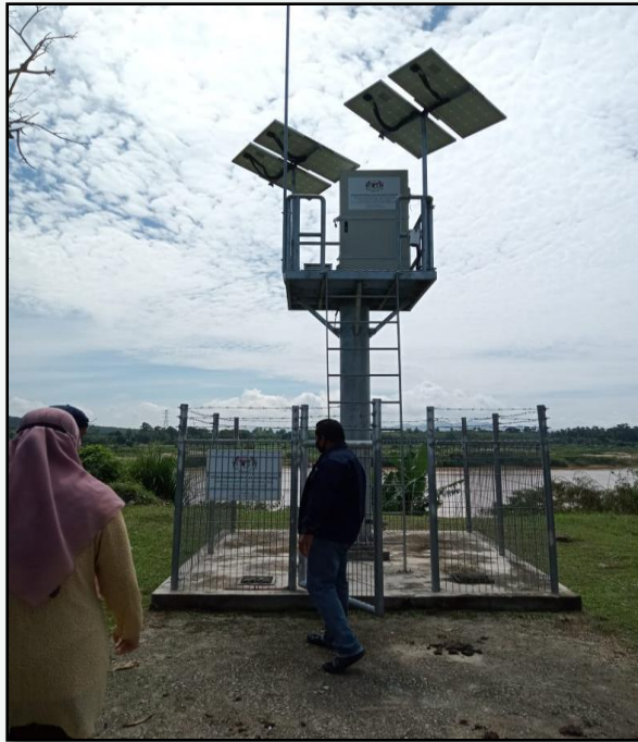
Gambar 2.7 Kelantan: Stesen pengawasan kualiti air sungai automatik
