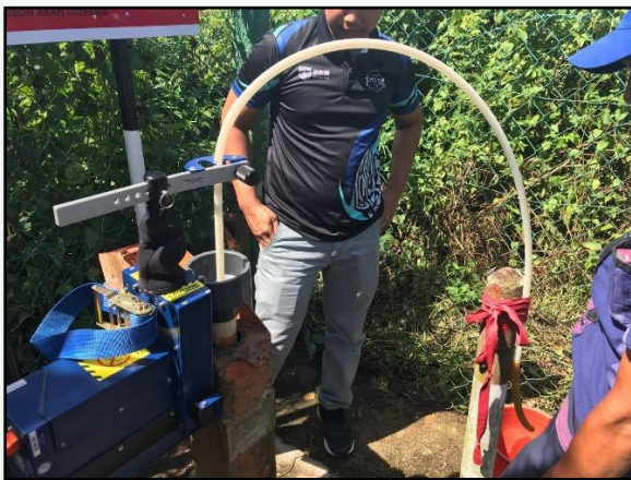
Gambar 2.9 Kelantan: Kerja-kerja persempelan air bawah tanah.
