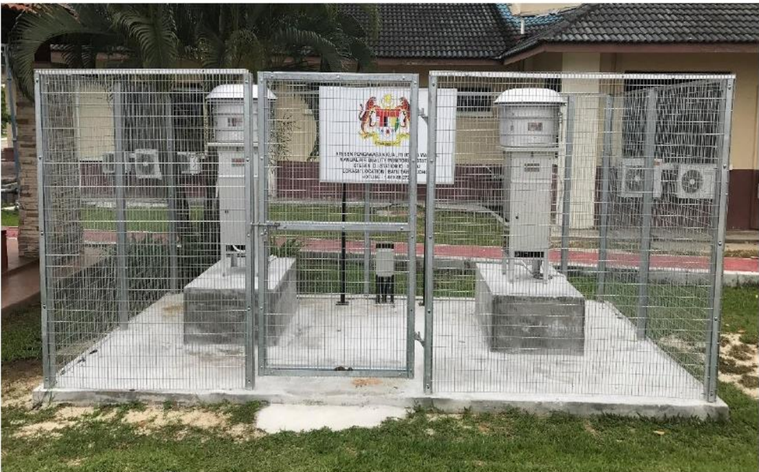
Gambar 6.2: Stesen Pemantauan Kualiti Udara Automatik di Batu Pahat, Johor
