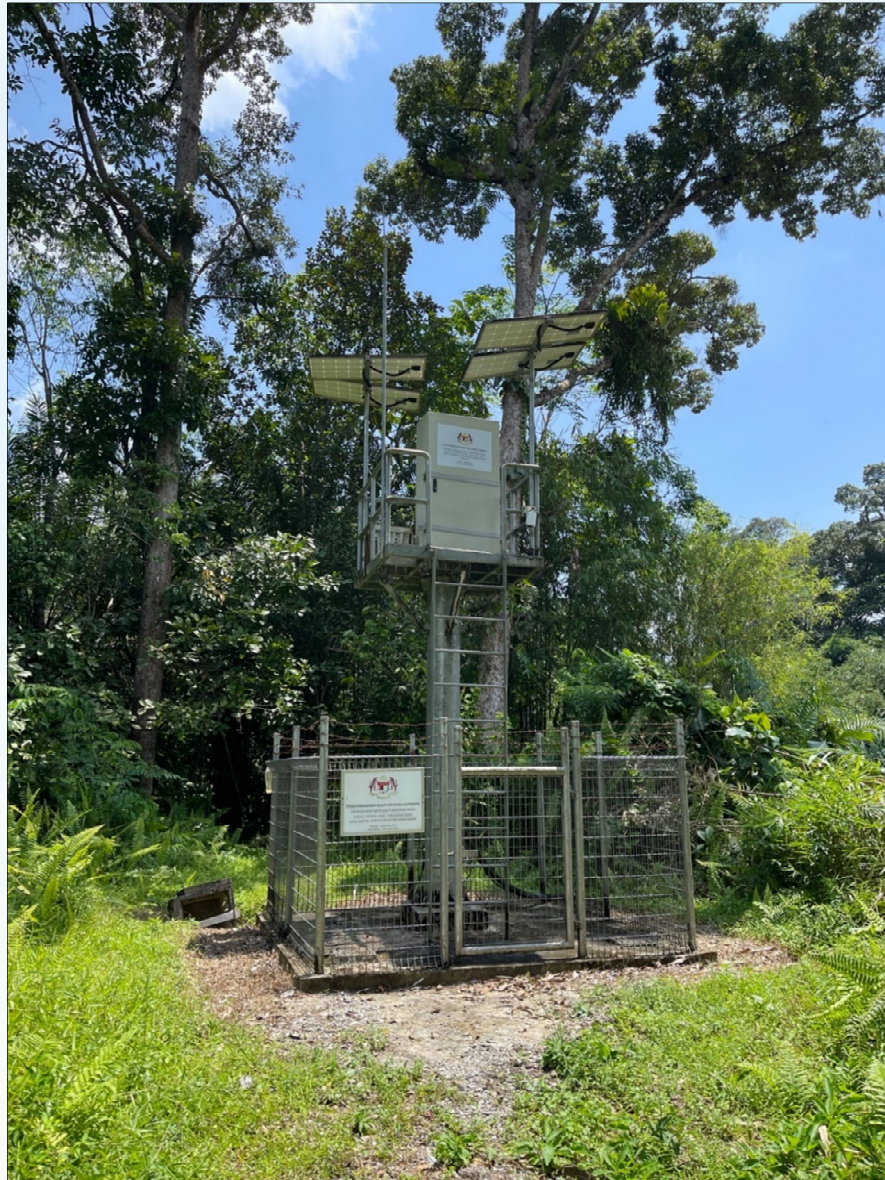
Foto 4.5: Stesen pengawasan kualiti air sungai automatik (CRWQM) yang terletak di Batang Sadong, Serian
