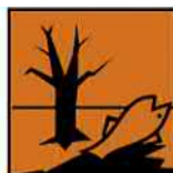
Eco hazard (N)
