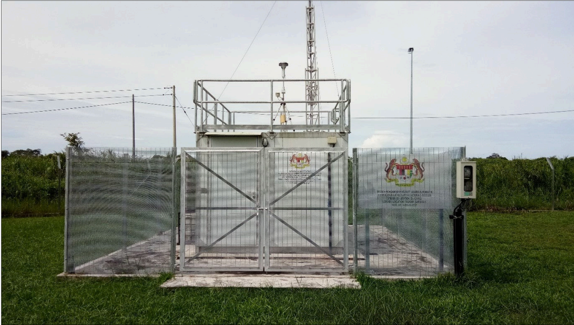
Foto 4.11: Stesen pengawasan kualiti udara automatik (CAQM) yang terletak di Politeknik Mukah, Sarawak
