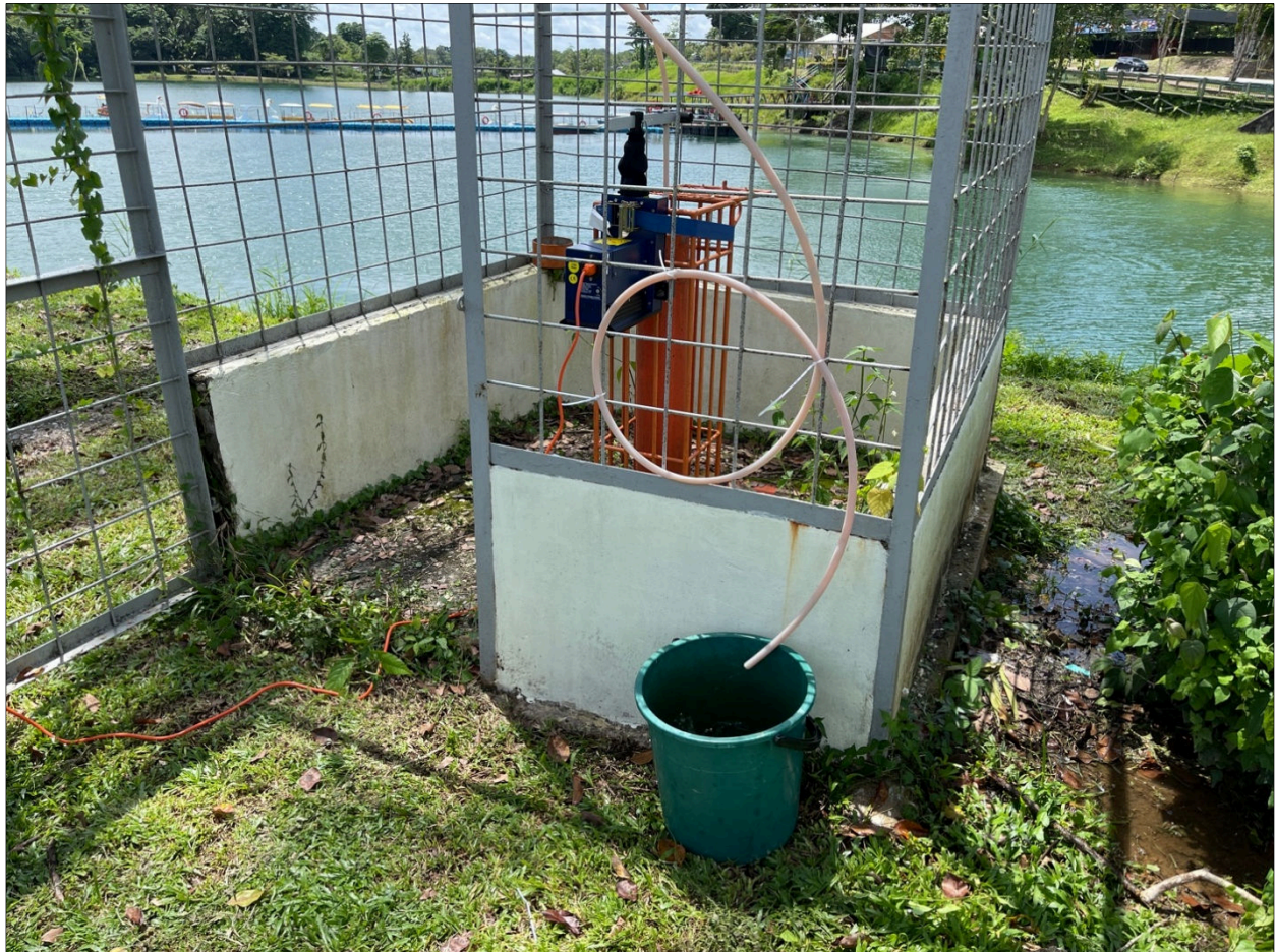
Foto 4.9: Stesen pengawasan kualiti air tanah yang terletak di Tasik Biru, Bau
