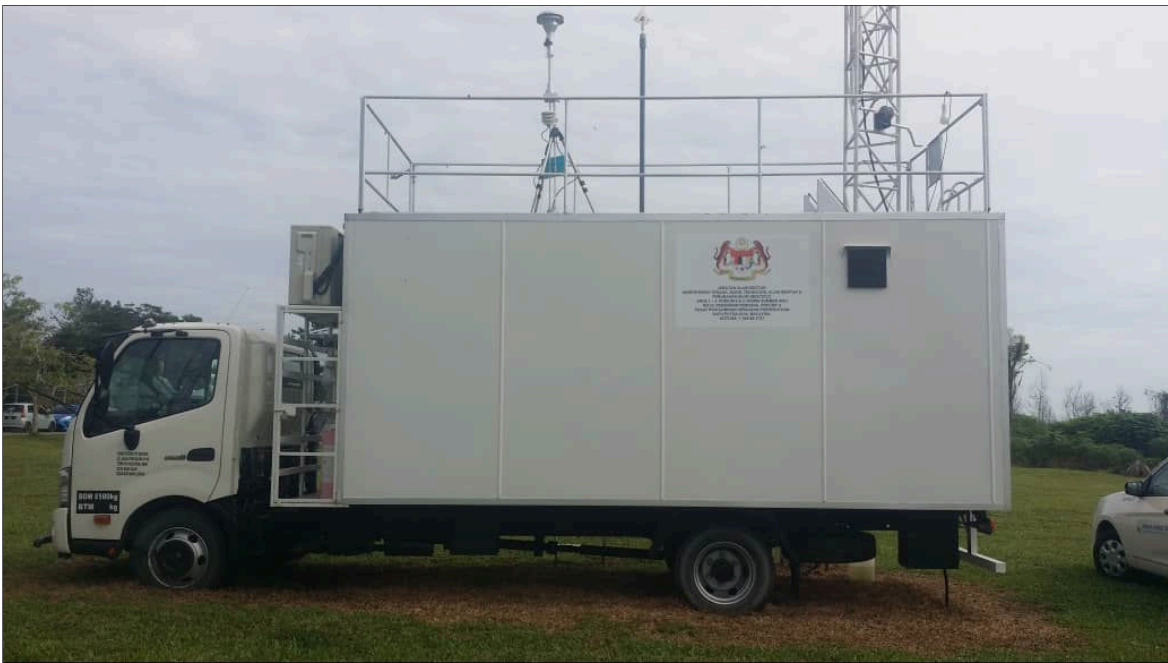
Foto 4.12: Stesen pengawasan kualiti udara automatik bergerak (MCAQM) yang terletak di Ibu Pejabat Polis Daerah Serian, Serian, Sarawak
