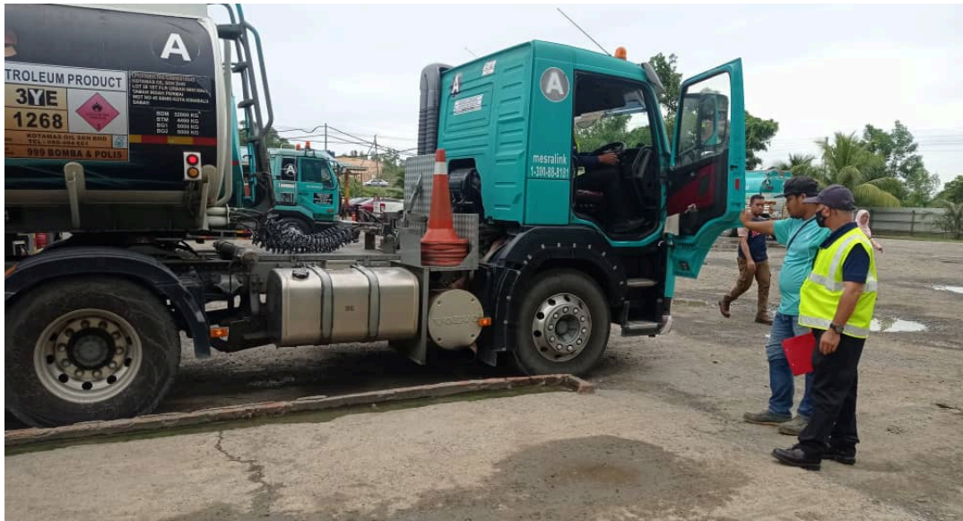
Gambar 6.0 : Ujian asap hitam dijalankan ke atas kenderaan diesel semasa operasi statik dijalankan.
