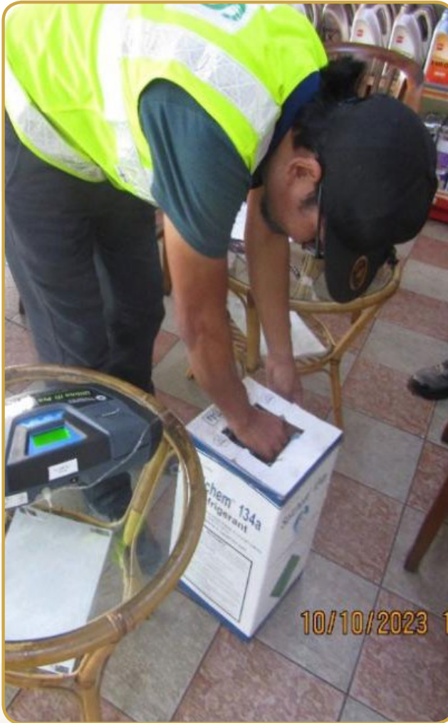
Gambarfoto 3.24 : Pemeriksaan Pematuhan dan Pengujian Dengan Menggunakan Refigerant Identifier
