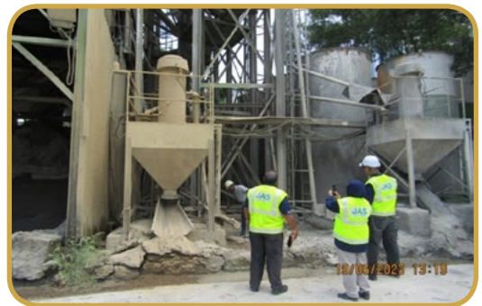
Gambarfoto 3.2 : Pemeriksaan Alat Penapis Beg, Alat Kawalan Udara Yang Terdapat Di Batching Plant
