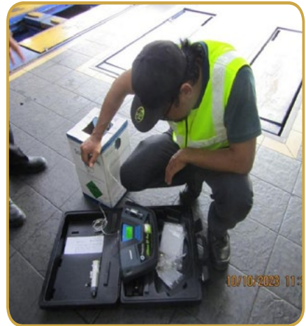
Gambarfoto 3.24 : Pemeriksaan Pematuhan dan Pengujian Dengan Menggunakan Refigerant Identifier
