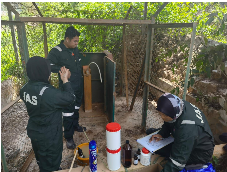
Gambar 4.42: Aktiviti Persampelan Kualiti Air Tanah Di Stesen Air Bawah Tanah, Tapak Pelupusan Sampah Sungai Udang
