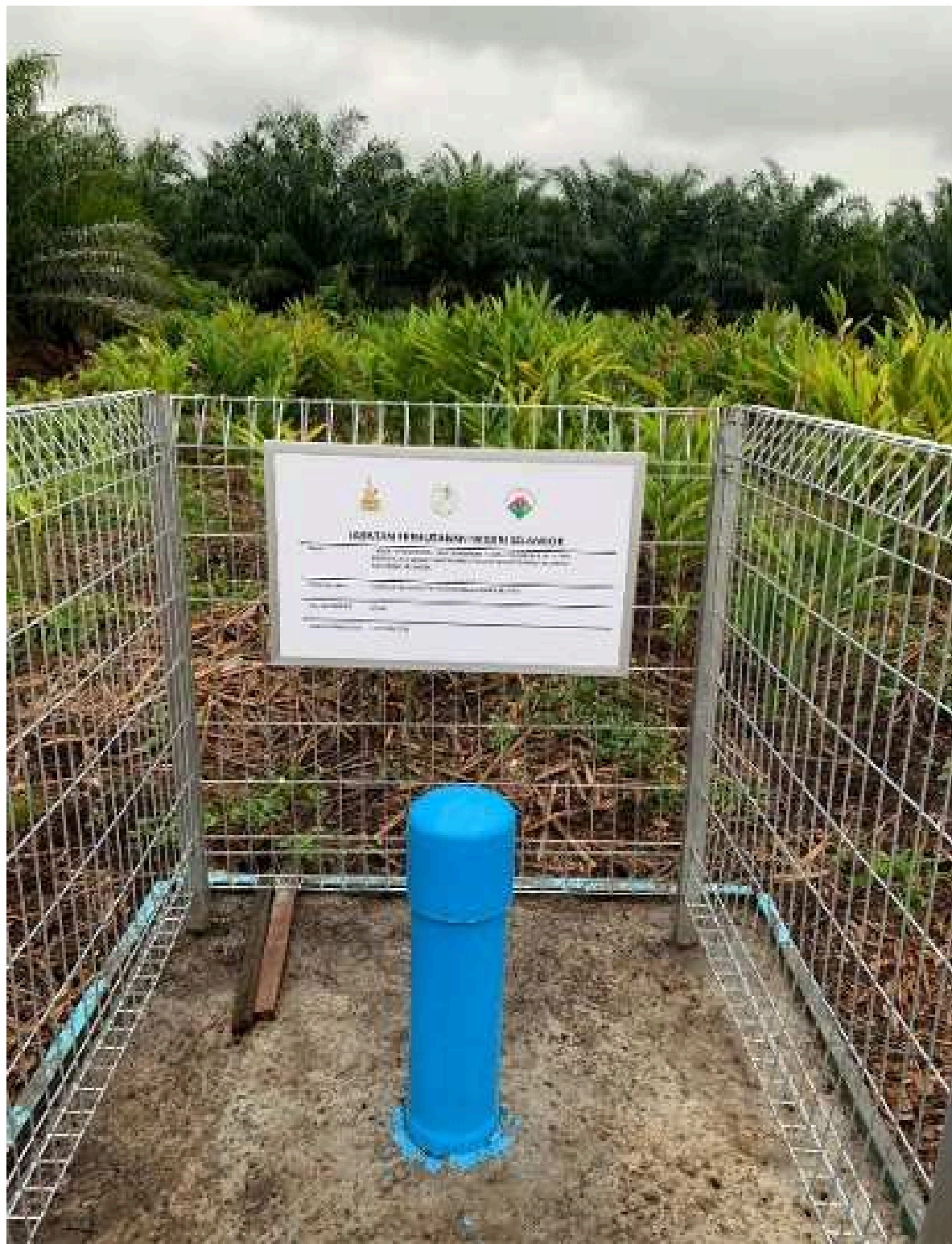
Foto 4.17: Piezometer yang dibina di kawasan fire prone di Negeri Selangor
