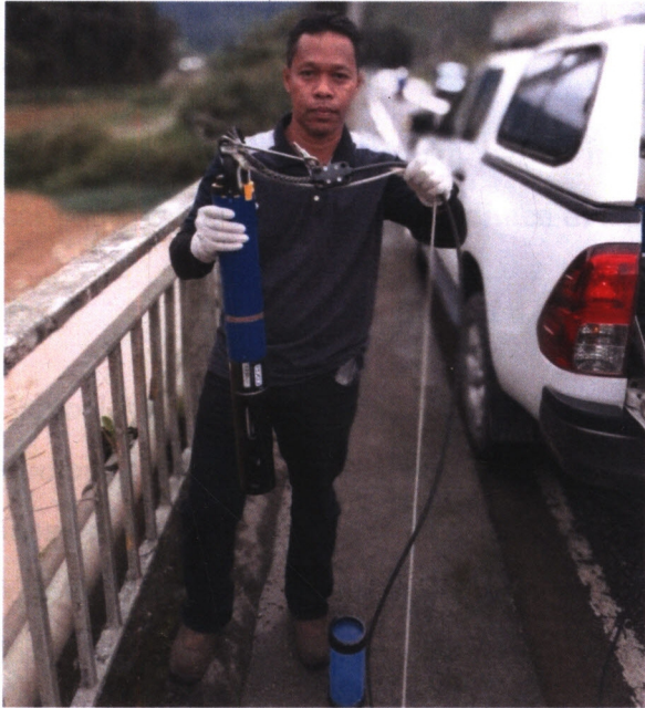
Pengukur insitu multiparameter (pH, suhu, DO, kekeruhan, dan konduktiviti)
