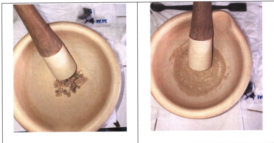
Rajah 3.7 Penumbuk lesung untuk hancurkan sampel sedimen
