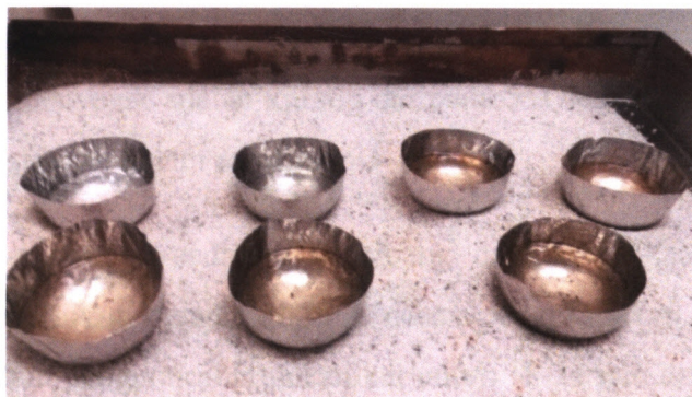
Rajah 3.9 Sampel sedimen dipanaskan di atas pengukuh pasir.
