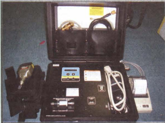
Gambar 4.21 : Sabah : "Refrigeran Identifier " . Alat Yang Digunakan Untuk Menguji Gas Dalam Alat Pendingin Udara Kenderaan.
