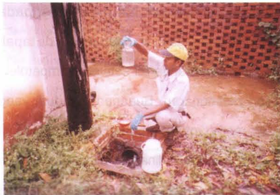
Gambar 4.14 : Sabah : Persampelan Bagi Parameter Minyak & Gris.
