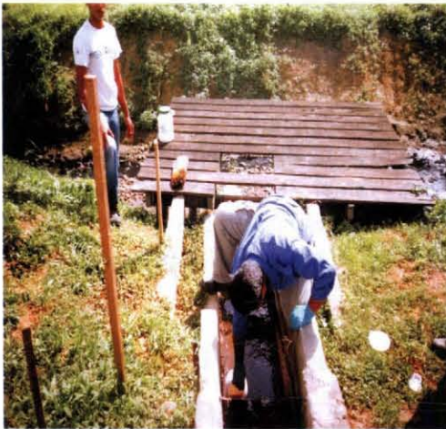
GAMBAR 4.16 Persampelan effluen kilang kelapa sawit untuk land irrigation
