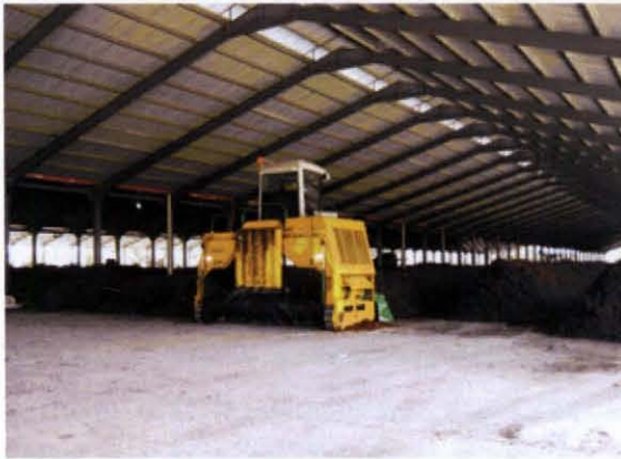
Gambar 4.11: Teknologi pelupusan tandan kosong dan effluen menggunakan kaedah kompos berbumbung (pertama di Malaysia)
