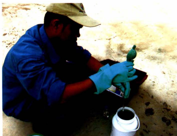
Rajah 4.5 : Pengawetan Sampel Kilang Getah sedang di lakukan di tapak
