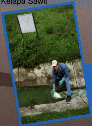
Gambar 3.4 : Pengambilan sampel di takat pelepasan terakhir yang diluluskan bagi Kilang Kelapa Sawit
