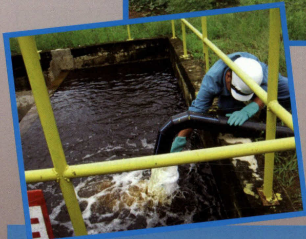
Gambar 3.4 : Pengambilan sampel di takat pelepasan terakhir yang diluluskan bagi Kilang Kelapa Sawit
